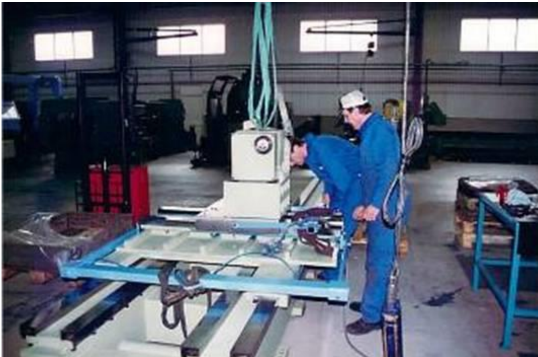
Bild 5.2 Es wurde alles genau nach den Werkzeugmaschinen Vorschriften hergestellt, auch der Winkel von der X zur Z Achse vorgesehen, dass hol drehen erfolgt, ohne dass das im Kunden Werk eingeschabt werden musste.
