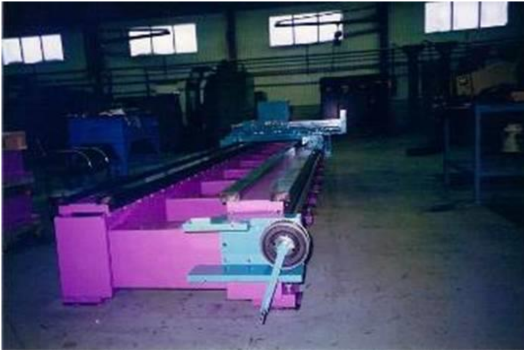
Bild 5.1. Die WIAP hat dann ein neues Maschinen Bett vorbereitet, Systeme WIAP DM4C, das dem Kunden geliefert wurde und vor Ort der Austausch erfolgen konnte
