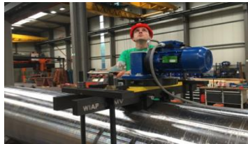
Walzen beim Metall entspannen mit Vibration (MEMV) – Jim Peter Widmer – April 2017 (hpw)
