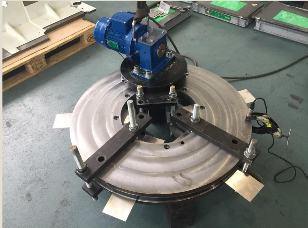
Ringe, die vor dem Fertigbearbeiten MEMV entspannt werden, haben keinen Verzug bei der Bearbeitung
