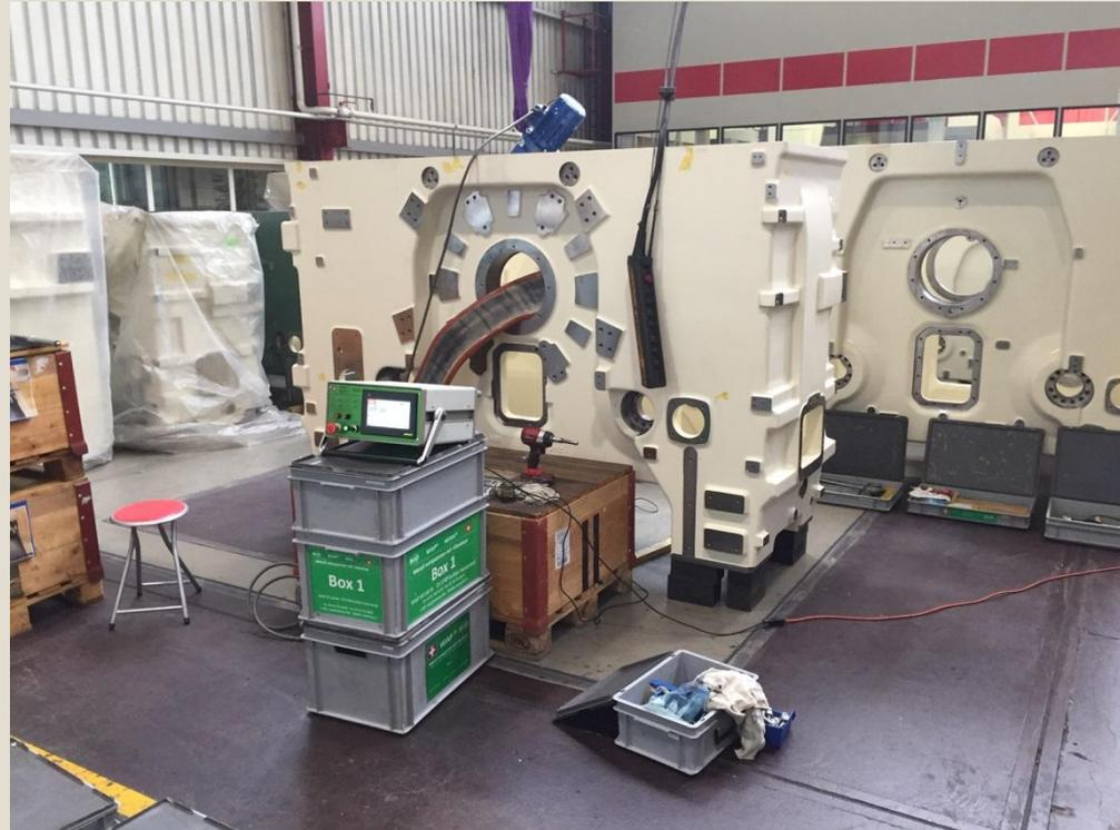
Gussgehäuse die Spannungsverzug haben beim bearbeiten.
