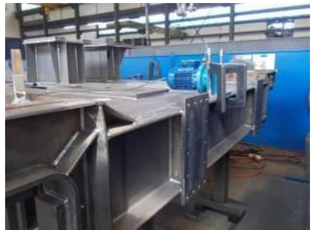
Вибационное снятие напряжений в тонкостенных, больших сварочных конструкциях в Центральной Швейцарии, 2012 год
