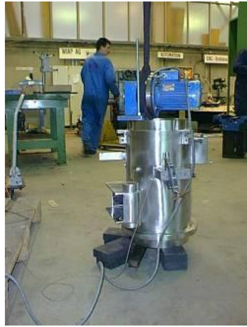
Нержавеющий бак одного швейцарского клиента во время вибационного снятия напряжений.
