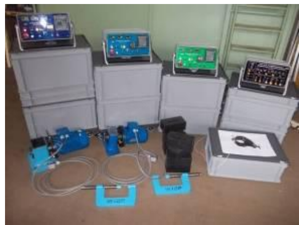
Система снятия напряжений вибрацией WIAP
