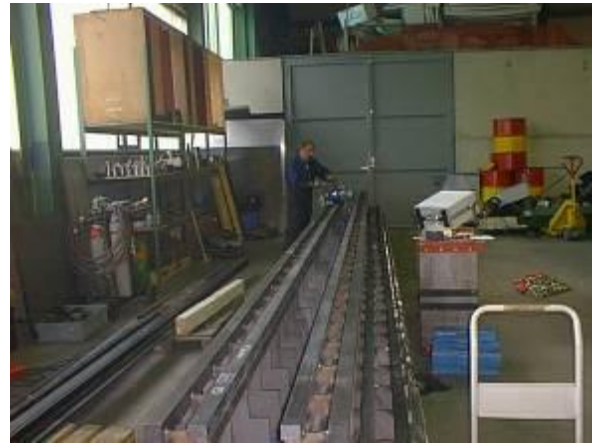
Вибрационное снятие напряжения в станине бiльшого станка с 8 направляющими
