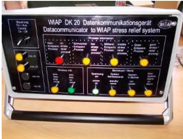
Устройство для передачи данных WIAP DK 20
