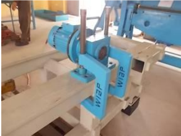
Возбудитель LC 20 снимает напряжение в станине машины Wiap
