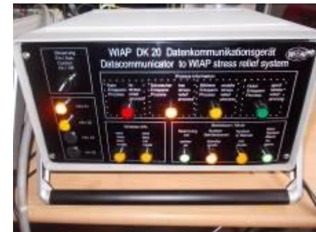
Фото 6: Устройство для передачи данных, для связи LC с ноутбуком.
