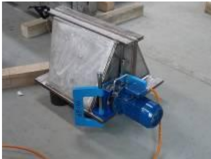
Фото 10: Вибратор Wiap на детали фирмы Voith
