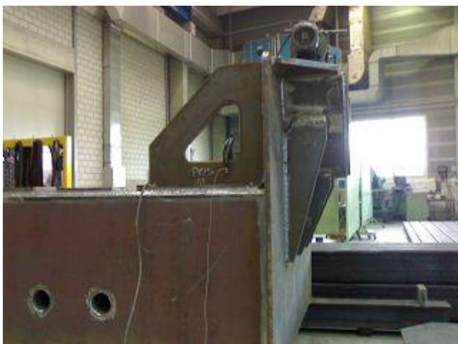
Фото 9: Напряжения в крановых конструкциях снимаются вибрацией.
