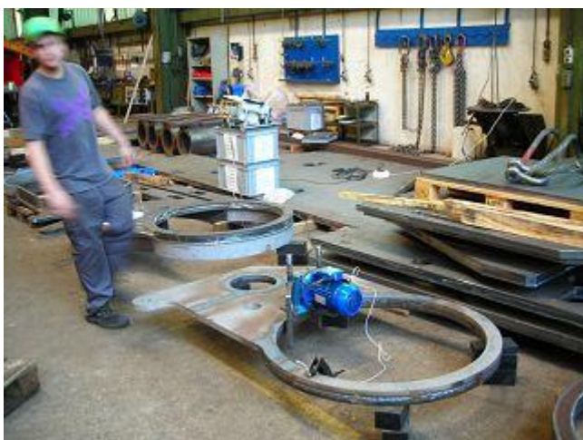
Фото 11. У вигоревших кольца перед обработкой напряжения снимаются вибрацией
