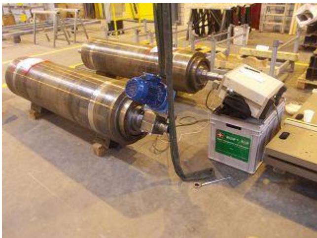
Фото 5: У изготовителя валов без вибрационного снятия напряжений возникают искривления на много десятых мм, прежде всего после твёрдого хромирования. Если б напряжения снимались вибрацией, то искривления можно было б уменьшить во много раз.
