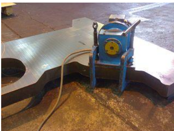
Фото 8: У подготовленных плитах перед конечной обработкой напряжения снимаются вибрацией.
