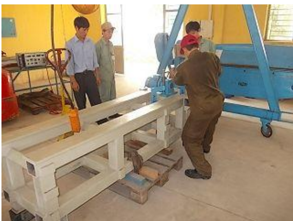
Фото 14: Здесь напряжения вибрацией снимаются в каркасе токарного станка
