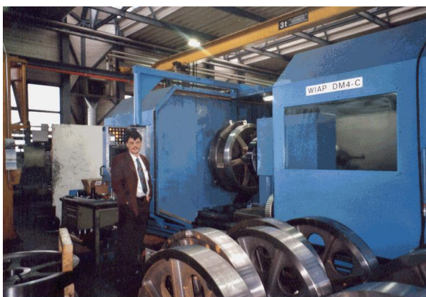
Фото 16б: Много таких CNC Wiap DM4C, 24 тонных, токарных станков изготовил Wiap для Анголы и Швейцарии. Напряжения у всех машин снималось вибрацией.
