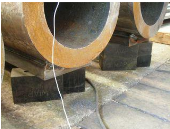
Фото 13: Каждая деталь должна лежать на резине, для того чтоб никакое колебание не переходило на помещение.
