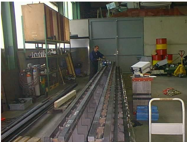
Фото16а. У 12 м станины с 8 направляющими напряжение тоже снимается вибрацией.
