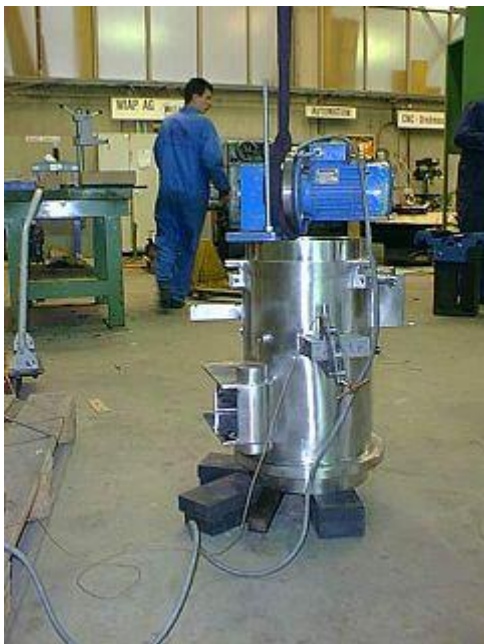
Фото 4: Вибрационное снятие напряжений во многих нержавеющей баках. Специалисты, которые занимаются обработкой, говорят, что у деталей, напряжение у которых было снято вибрацией, не имеют искривления и это не мешает дальнейшей обработке.
