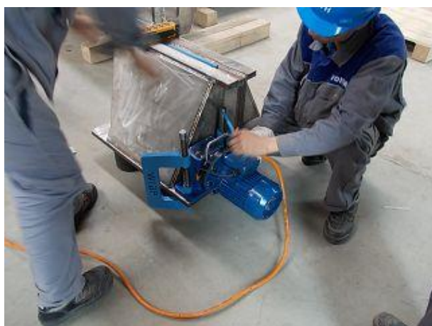
Фото 3: На фирме Voith China напряжения у всех деталей снимаются вибрацией.
