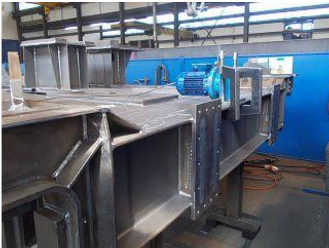
Фото 10: Тонкостенные конструкции могут с помощью незначительной силы очень сильно колебаться. Благодаря равномерному, одновременному установлению вибратора через возбудитель V одновременно снимаются и все напряжения.
