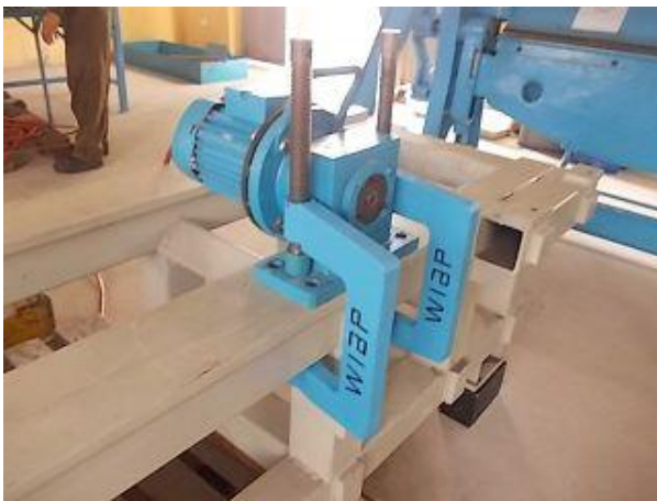
Фото 15. Вибратор нужно очень сильно соединить с деталью
