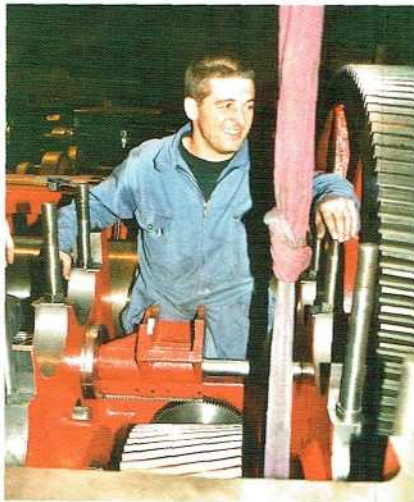
Demontage der Getriebewelle
