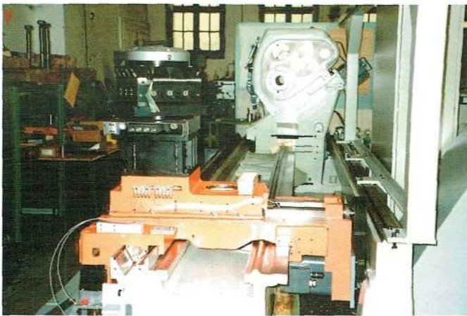
Bett mit Kreuzschlitten in Montage
