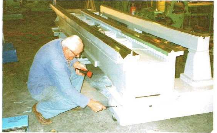
Ausrichten vor der Wiedermontage nach dem Schleifen des Bettes
