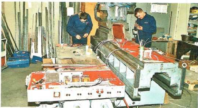
Kreuzschlittenmontage im Werk WIAP, Gewicht des Schlittens: 14 Tonnen
