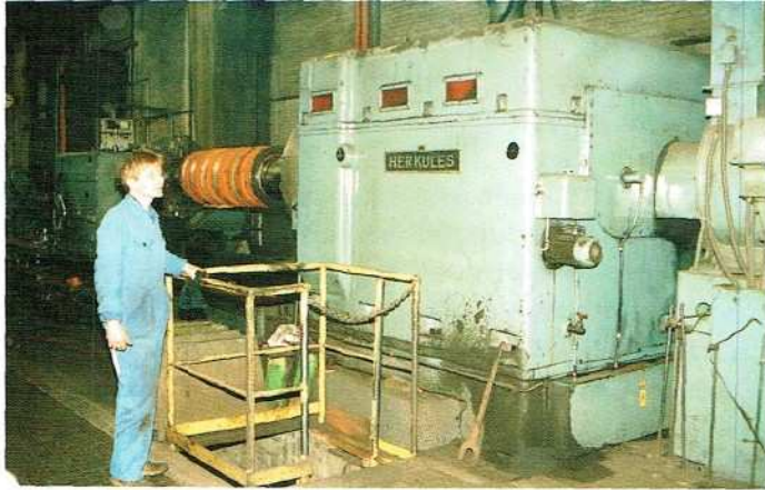
Getriebedemontage: 17 Tonnen Spindelstockgewicht
