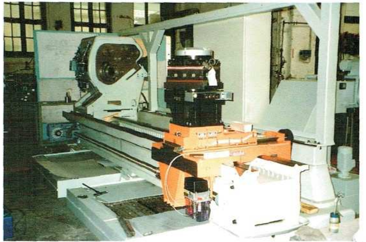
Bett mit Vorbereitung für Verschalung
