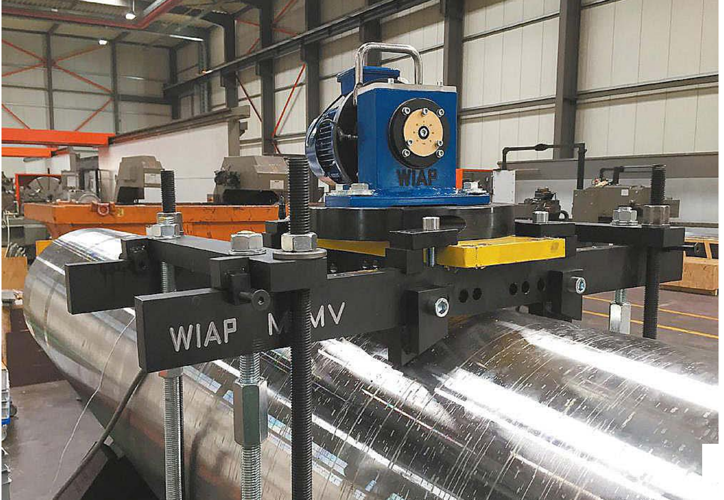
Vibrasjonsbehandling av komponenter foregår i kundens eget verksted. Foto: WIAP AG
