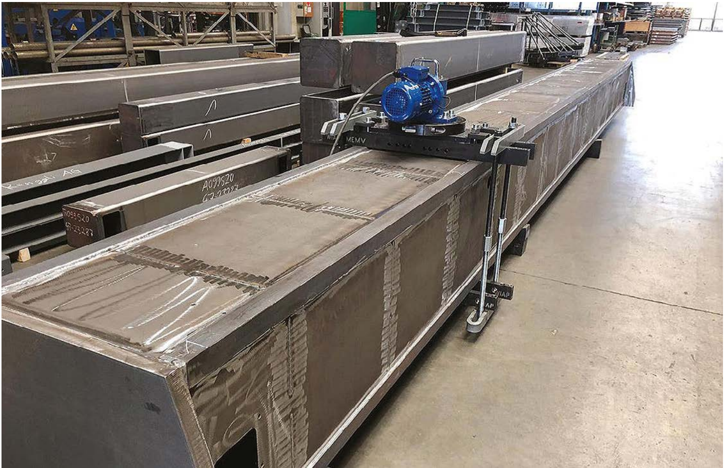
WIAP MEMV-teknologi benyttes på sveist konstruksjon. Foto: WIAP AG
