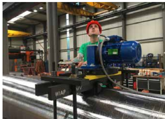
Abb. 2: Walzen beim Metall entspannen mit Vibration (MEMV) – Jim Peter Widmer – April 2017
