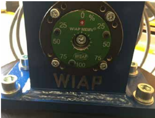
Abb. 7: Neuer V20-Anreger mit verschiedenen Einstellmöglichkeiten in % für unterschiedliche Excenterstufen – Oktober 2017 (hpw)
