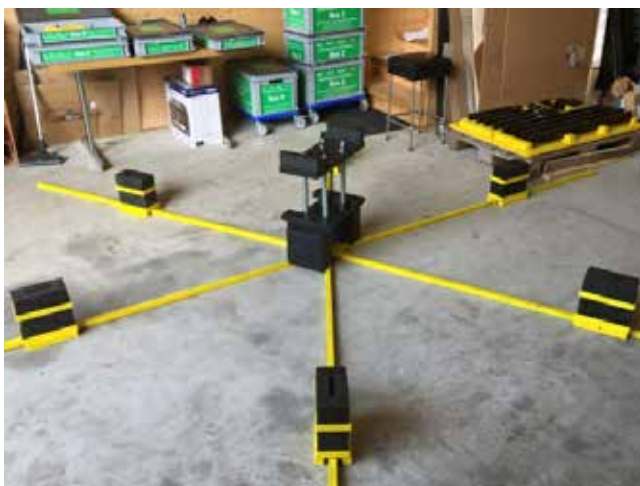
Abb. 8: Sterngummi-Bodenhalterung mit Axial-Erreger-Befestigungsvorrichtung
