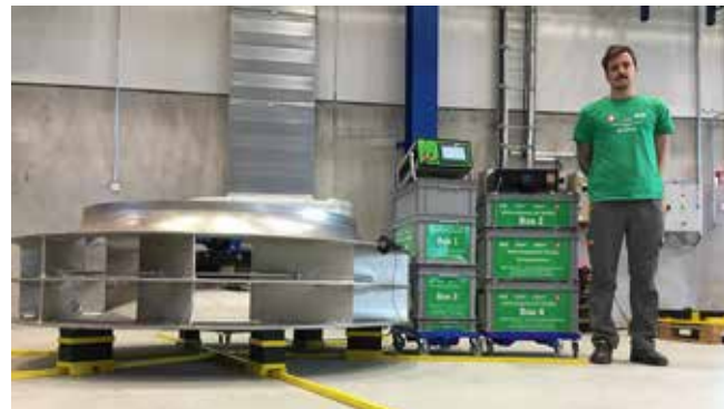
Abb. 1: Jim Peter Widmer in Tampere, Finnland, vor einer MEMV („Metall entspannen mit Vibration“)-Anlage der WIAP AG
