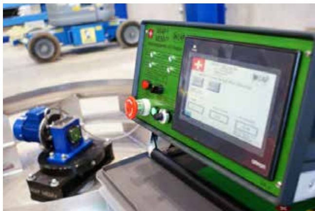
Abb. 11: Steuergerät WIAP MEMV mit V20-Erreger im Hintergrund, Tampere, FI – August 2017 (jw)
