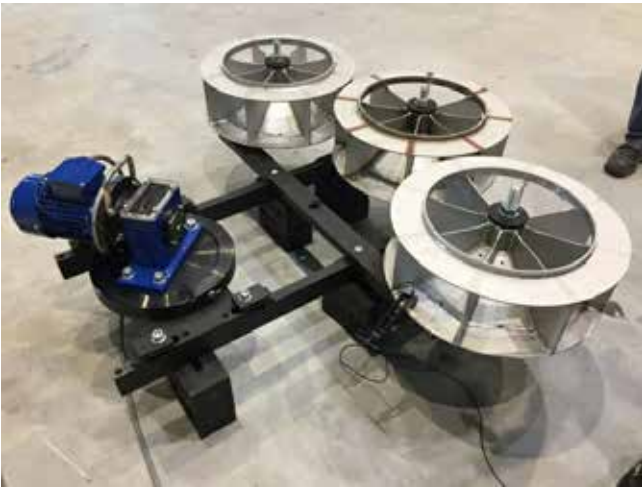
Abb. 9: Drei Impeller mit einem Durchmesser von 800 mm auf einer Mehrfach-Aufspannvorrichtung, Tampere, FI – August 2017 (hpw)
