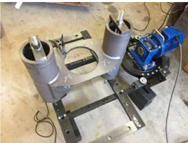
Abb. 10: Mehrfach-Aufspannvorrichtung, Kundenteil Thommen Safenwil – Oktober 2017 (hpw)
