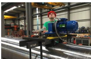
Bild 5. Walzen beim Metall entspannen mit Vibration (MEMV) – Jim Peter Widmer – April 2017 (hpw)
