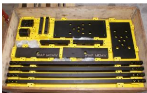
Bild 15. Aufspann-Vorrichtung in axialer Richtung für einen Impeller – August 2017 (hpw)
