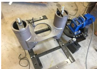
Bild 21. Mehrfach-Aufspannvorrichtung, Kundenteil Thommen Safenwil – Oktober 2017 (hpw)
