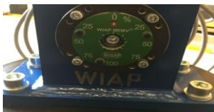
Bild 14. Neuer V20-Anreger mit verschiedenen Einstellmöglichkeiten in % für unterschiedliche Excenterstufen – Oktober 2017 (hpw)
