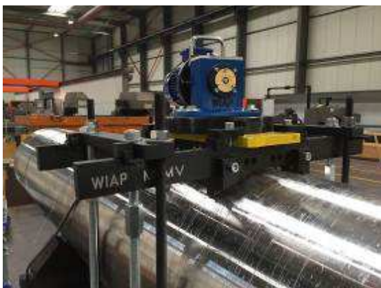
Bild 9b: Walzen -Aufspannvorrichtung – robust verbunden mit dem Bauteil
