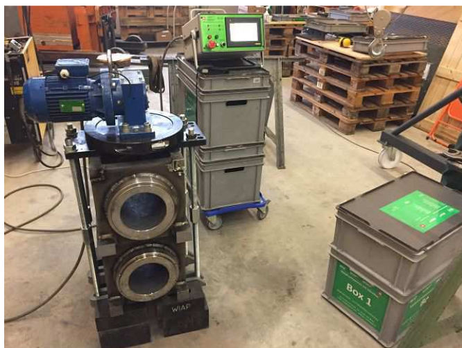
Bild2: Spindelstöcke: Vertikal MEMV ® entspannt mit einem Vielrichtungsverfahren
