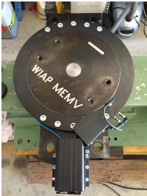
Bild 10: Vielrichtungs-WIAP-MEMV®-Automat mit automatischer Klemmung – Achsrichtung drehbar
