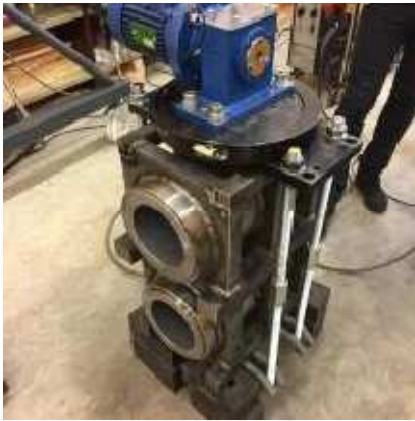
Bild1: Zwei Spindelstöcke werden mit der Multifunktionsmaschine WIAP DM3S vertikal mit dem MEMV ® (Metall entspannen mit Vibration)-Verfahren entspannt (alle Bilder: Hans-Peter Widmer)
