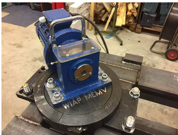
Bild 4: Das CNC-Multifunktionsmaschinenbett WIAP DM3S bei einer vertikalen MEMV®-Behandlung
