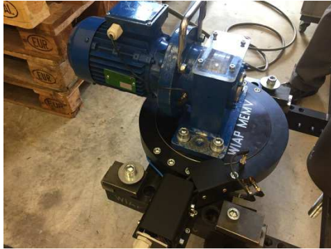
Bild 11: Vielrichtungs-WIAP-Vertikal-MEMV®-Automat mit V 20-Anreger
