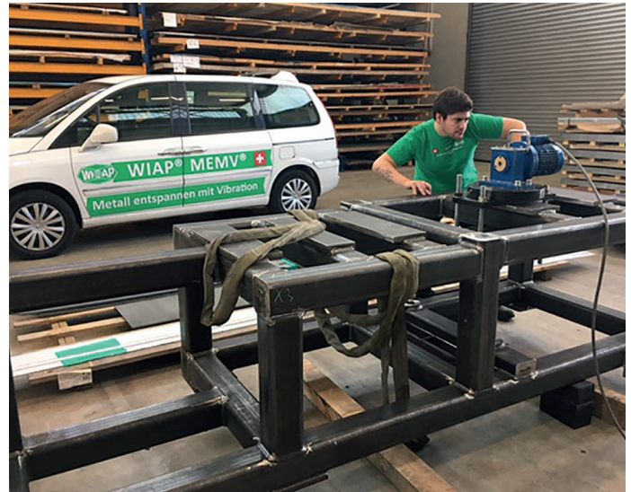
Sven Widmer bei einem Messtest mit 24 Messpunkten inklusive Protokoll-Erstellung.
