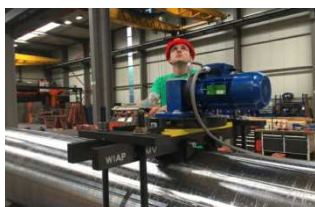
Валы во время снятия напряжений в металле с вибрацией (MEMV) - Джим Питер Видмер - апрель 2017
