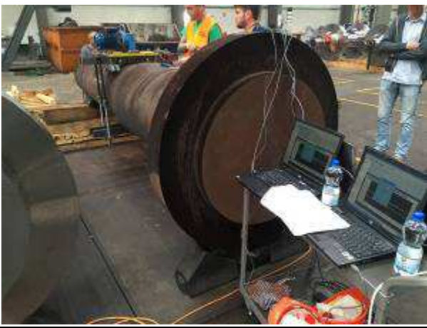
Bild 2: Und sie ist verzerrt nach dem Spannungsarm Glühen
