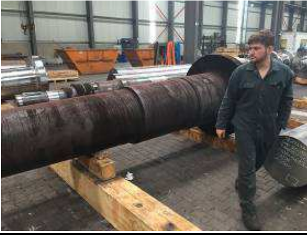
Bild 1: Diese 12000 KG Walze Spannungsarm Glühen benötigt 935 KW/H
