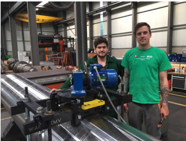
Bild 3: Die Walze vibrieren nach dem System WIAP MEMV braucht 2 KW/h. D.h über 400x weniger Energieaufwand und der Transport fällt auch weg.
