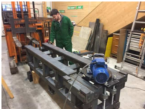
Bild 3: WIAP Vertikal MEMV®-Anreger in 45°-Anordnung: Die Bauteilvermessung am WIAP DM3S-Maschinenbett liefert hierbei wertvolle Informationen über den Prozessverlauf
