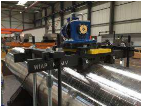
Bild 2: Die Walzen-Aufspannvorrichtung sorgt für eine robuste Verbindung mit dem Bauteil
