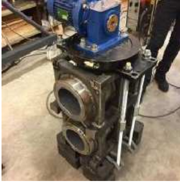
Bild 1: Zwei Spindelstücke werden mit der Multifunktionsmaschine WIAP DM3S vertikal mit dem MEMV® (Metall entspannen mit Vibration)-Verfahren entspannt (alle Bilder: Hans-Peter Widmer)
