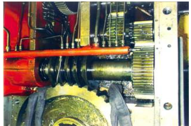
Der ganze Längsschlitten Vorschubantrieb, welche die Zahnstange antrieb, war komplett ausgelaufen. WU4310
