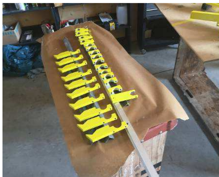
Bild 83: Die Krallen um das Rohteil und Fertigteil in die Auflage zu drehen. Was bewegt, gelb
