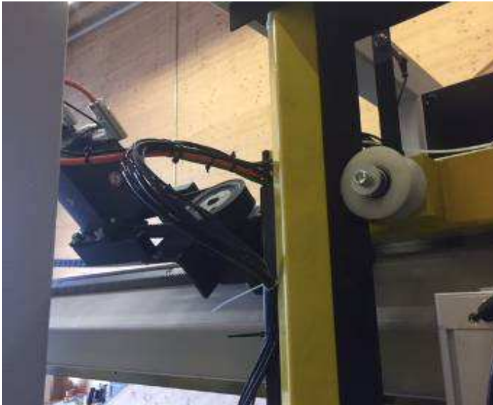
Bild 97: Mit 40 kg bis 4 Meter lange Stanken in ein Futter fahren benötigt eine stabile Lösung. Wir haben mit dem Stahl Gewicht nicht gespart
