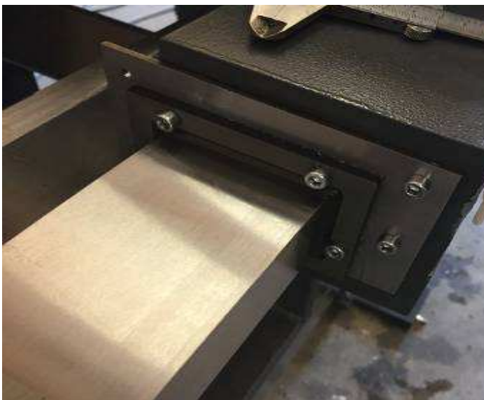
Bild 50: Wir haben eine neue Führungsgrösse 40x70 mm gewählt und auch gleich eine Form beim Abstreifer Hersteller gekauft, damit wir dieses Model serienmässig einsetzen können. An Lager haben wir für 3 Maschinen
