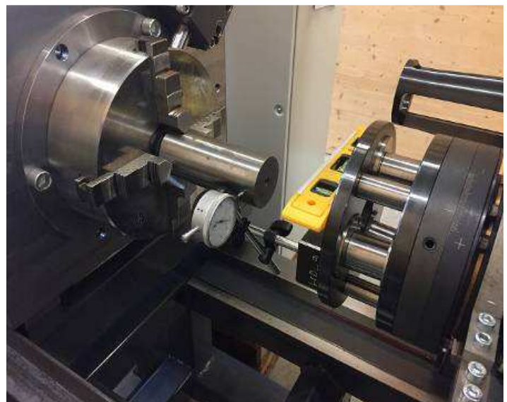
Bild 60: Unter dem Futter, wie auch bei den beiden Spindeln, hat es Unterlagen die eingeschliffen werden können, d.h. das Ausrichten ist nicht so schwer
