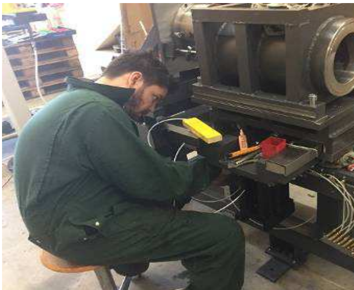
Bild 46: Sven, Montage der Schmierung
