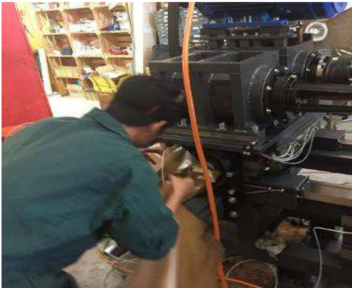
Bild 58: Montage von Einstellschrauben, dass der Spindelstock im hunderstel ausgerichtet werden kann. Er hat auf beiden Seiten Referenzflächen zur Spindelbohrung, dass auch das Riemen nachspannen einfach ist
