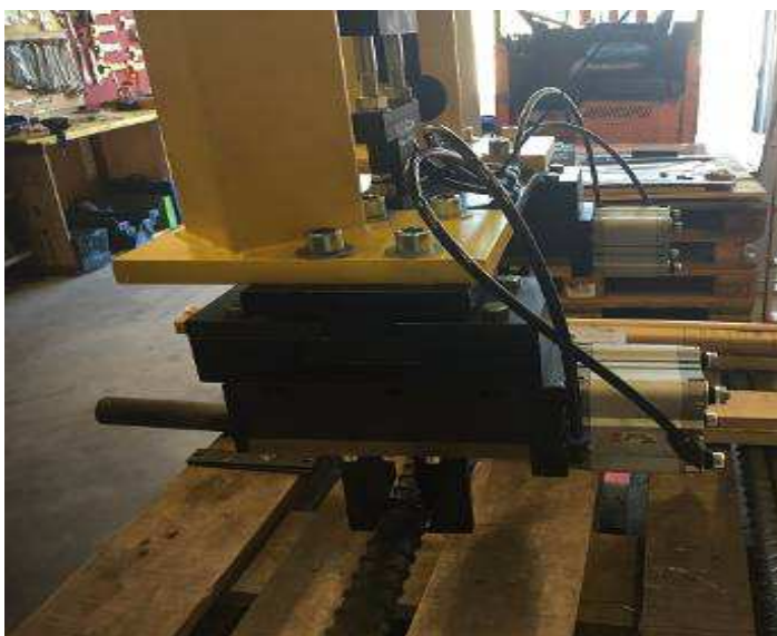
Bild 41: 2 Greifer für 40 kg. Es könnten sicher auch 80 kg gehoben werden
