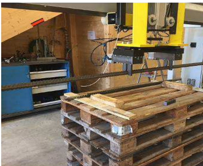
Bild 42: Test des Greifers mit dem HLV (Hilfsladevorrichtung)
