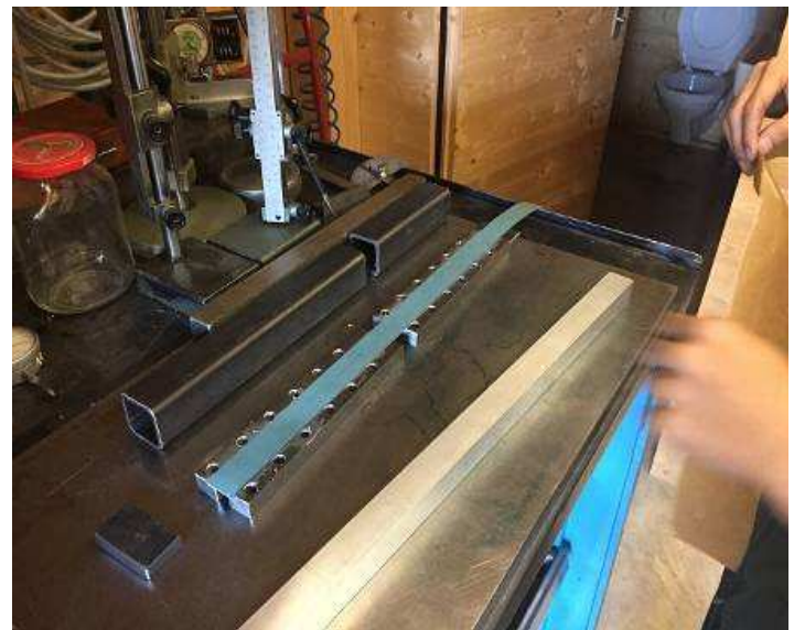
Bild 40: Der Untergriff. Damit es nicht Stahl auf Stahl ist, nehmen wir auch Gleitbelag
