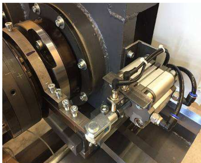
Bild 67: Normschalter, Normzylinder; pflegeleicht für den Unterhalt
