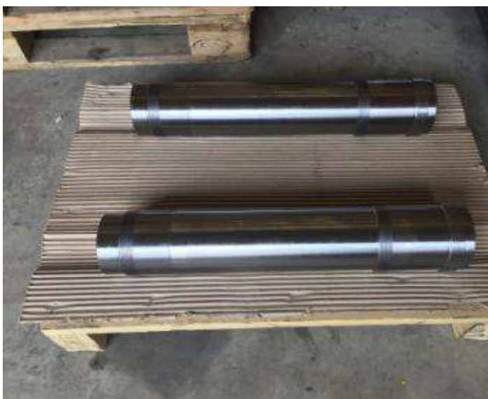
Bild 20: 2 identische Spindeln geschliffen
