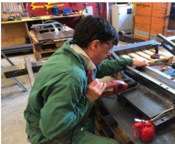
Bild 25: 150 mm tief bohren für die Schmierung
