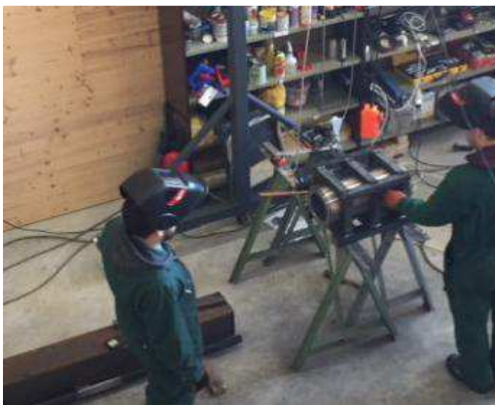
Bild 17: Jim und Sven schweissen die Spindelstock Gehäuse
