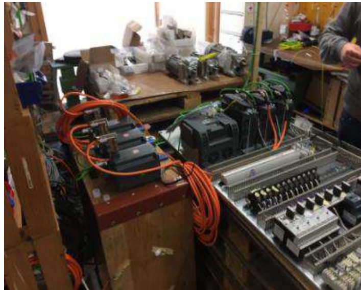
Bild 6: Alles ist aufgebaut zum testen, damit, wenn wir die Maschine mechanisch fertig haben, alles schon läuft und voreingestellt ist
