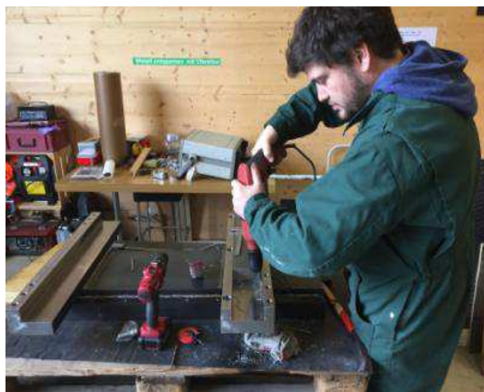
Bild 23: Mehrere hundert mm Schmierkanäle bohren, dass der Eintritt nur auf einer Seite pro Bahn ist
