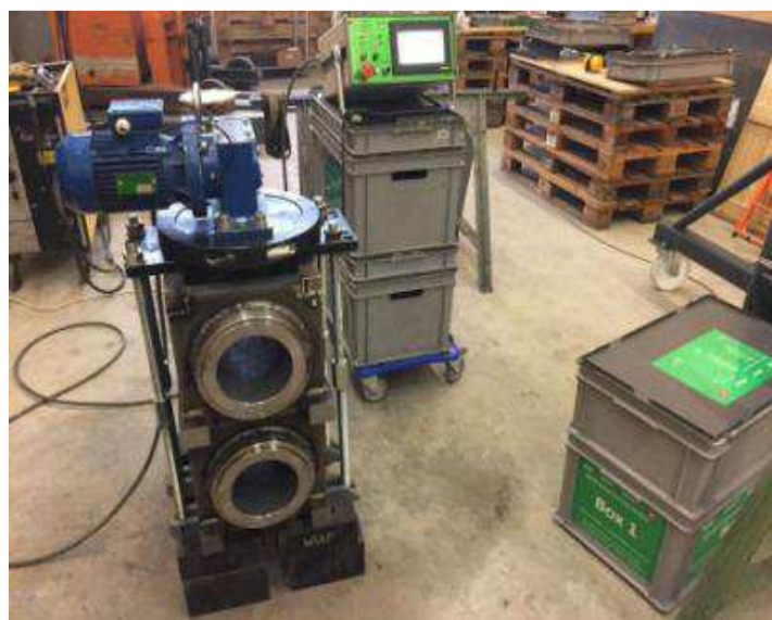
Bild 18: 3 Richtung MEMV Entspannen. Protokollieren der Entspannung beider Spindelstöcke
