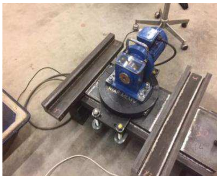
Bild 22: Hier wird der Z-Schlitten MEMV in 4 Achsrichtungen vibrationsentspannt
