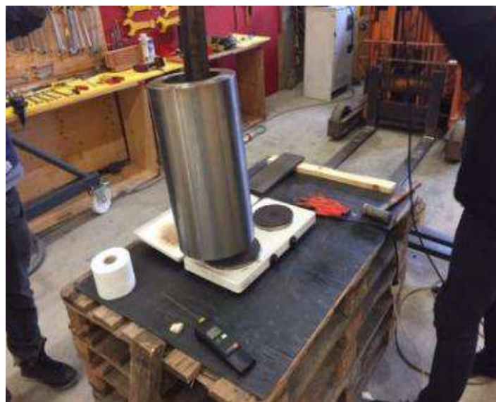
Bild 15: Heisschrumpf System, dass das Gewicht und die Bearbeitungskosten beweglicher waren
