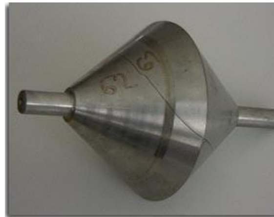
Eigenennungsbedingter Riss in einem Kegelrad
