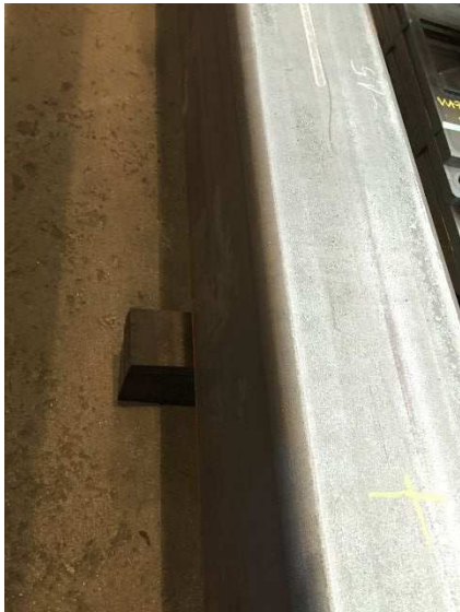
P8: Sehr wichtig ist eine gute Gummiunterlagerung. Diese sollte eine genügende Höhe haben, damit keine Schwingungen in ein Fabrikgebäude übertragen werden. Zudem ist die Protokollierung fehlerfrei.
