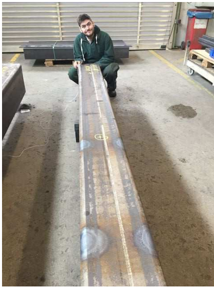
P5: Das Bauteil mit mehreren Erhitzungsstellen durch das Flammrichten .
