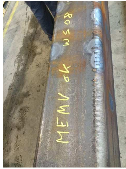
P2: Das Bauteil wurde flammgerichtet
