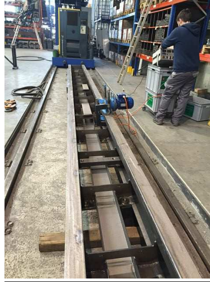
P9: Maschinenständer beim Entspannungsprozess. Auch dieser wurde flammgerichtet
