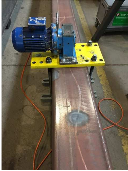
P1: Stabil verbundener MEMV® Erreger am Bauteil
