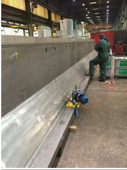
P11: Auch das schwere Maschinenschwert im Entspannungsprozess
