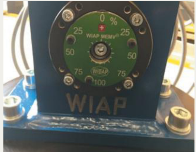
14.kép: Az új V20-as alapkészülék, százalékos excentrikus állítási lehetőséggel a különböző teljesítményszintek elérése érdekében -2017 október (hpw)
