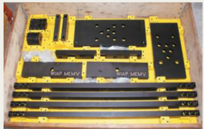
15.kép: Tengelyirányú felfogató készülék turbinakerekhez -2017 augusztus (hpw)
