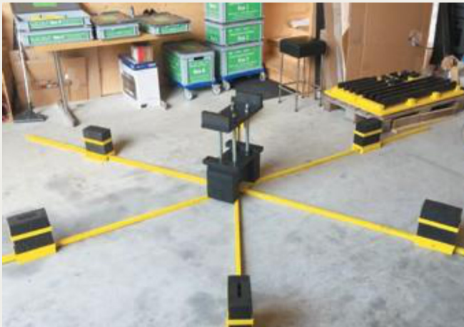
17.kép: Padlózati csillagállvány axiális rázókészülék rögzítéséhez -2017 augusztus (hpw)
