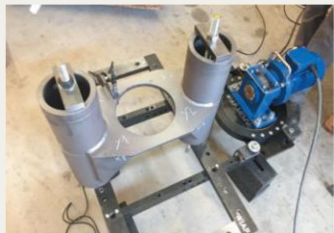
21.kép: Többfokozatú felfogatószerzám, munkadarabbal -2017 október (hpw)
