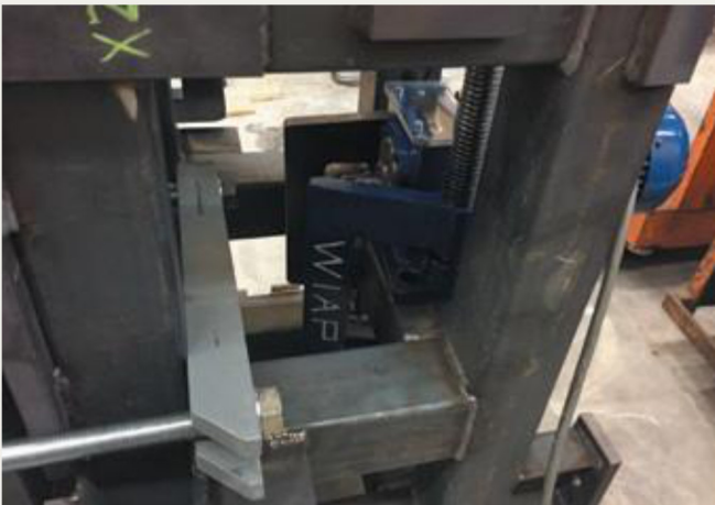
36.kép: VDSF eljárás alkalmazása; DM3S gépágy; vibrációs feszültségcsökkentés vibrációtompítással, Dulliken - 2018 február (hpw)
