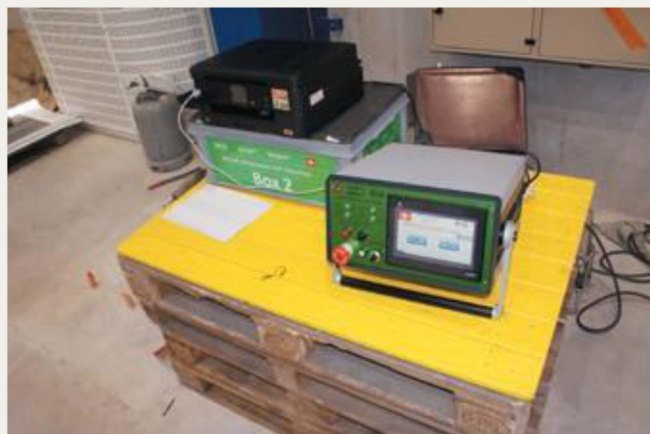
24.kép: Vezérlőegység WIAP MEMV nyomtatóval, és tárolódobozokkal -2017 augusztus (jw)
