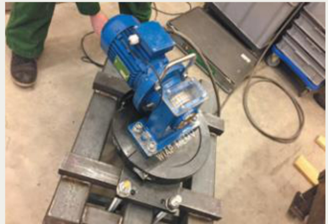
33.kép: Rögzítés szupportcsavaroseljárással, Dulliken - 2018 február (hpw)
