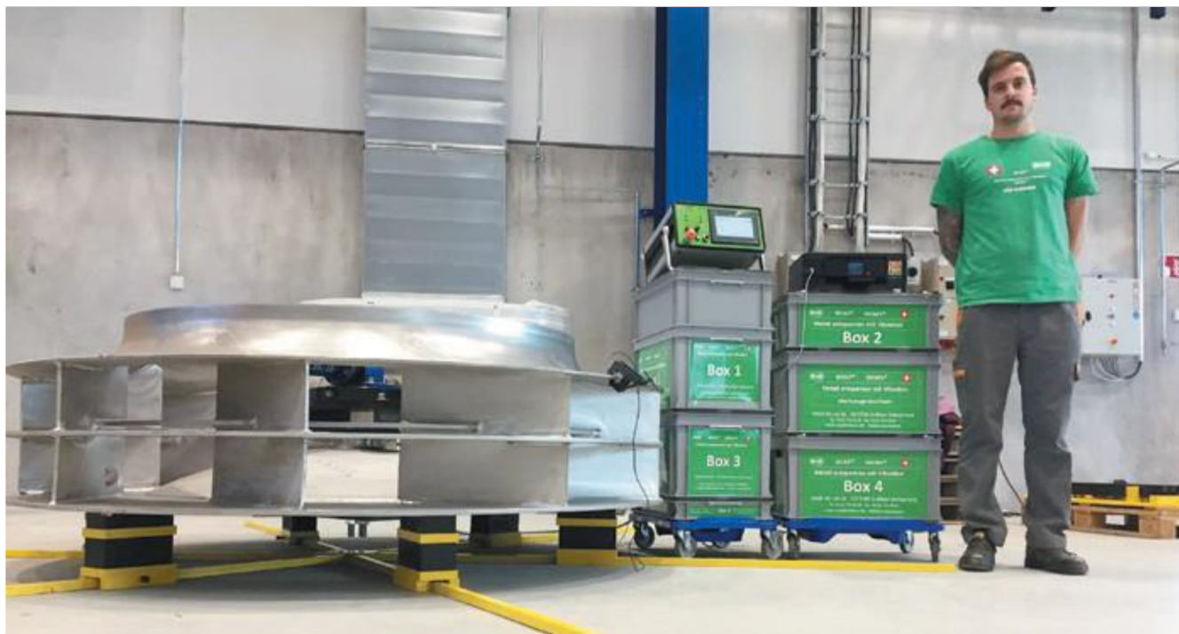
1.kép: Jim Peter Widmer a WIAP AG egyik MEMV („Metall entspannen mit Vibration”; vibrációs feszültségcsökkentő) gépe előtt -2017 augusztus (hpw - Hans-Peter Widmer)
