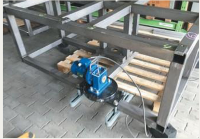
37.kép: Keretek vibrációs feszültségcsökkentése, Kelet-Svájc - 2018 január (hpw)
