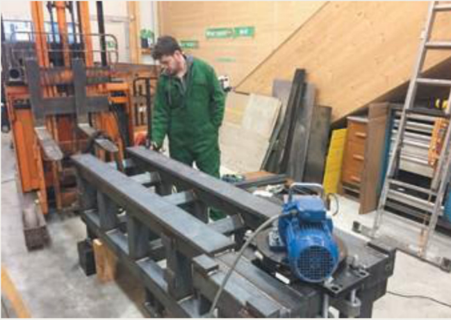
35.kép: DM3S gépágy; vibrációs feszültségcsökkentés, a hőkezelés kiváltására, Dulliken - 2018 február (hpw)
