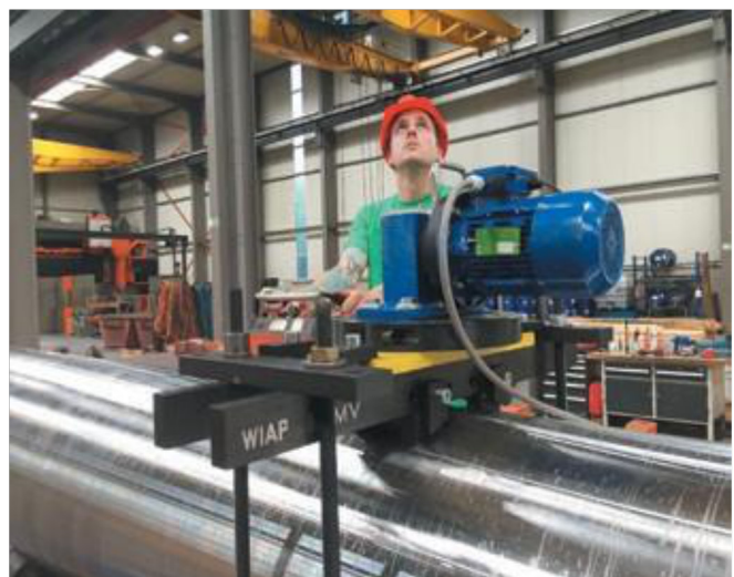
5.kép: Tengelyek a v i b r á c i ó s feszültségcsökkentésnél (MEMV) - Jim Peter Widmer -2017 április (hpw)
