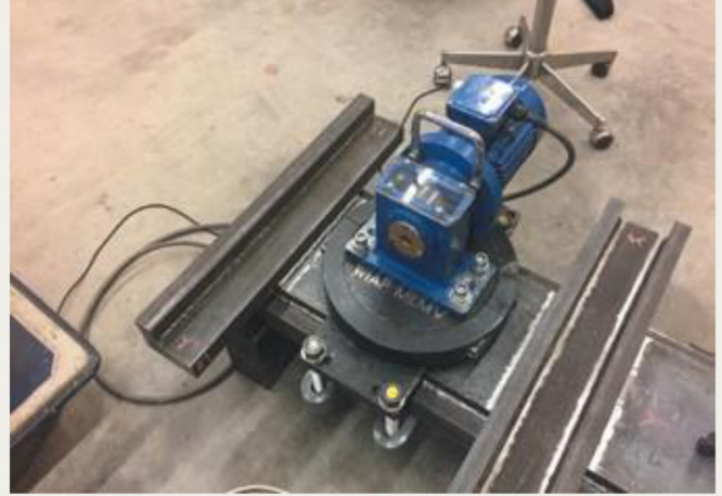
32.kép: WIAP CNC-multifunkcionális gép; DM35 vibrációs feszültségcsökkentés, Dulliken (hpw)
