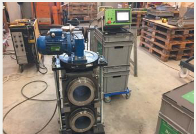
34.kép: Rögzítés duplaszupportcsavaros eljárásal, Dulliken - 2018 február (hpw)
