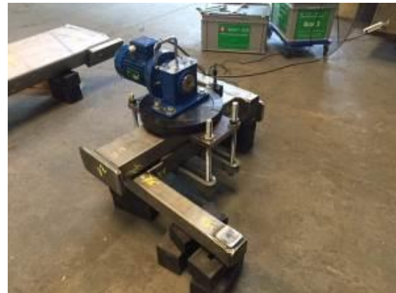
Hårdvara med dubbel spänning. 14 mätpunkter för resultatet loggning 2D axiell riktning
