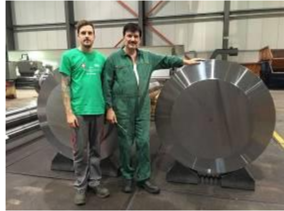
2 rullar, varav en var som med vibrationer. I stället för den andra rullen med WIAP® MEMV® att slappna av, var en glödgad roll tas. Länkar Jim Peter Widmer; höger Hans-Peter Widmer
