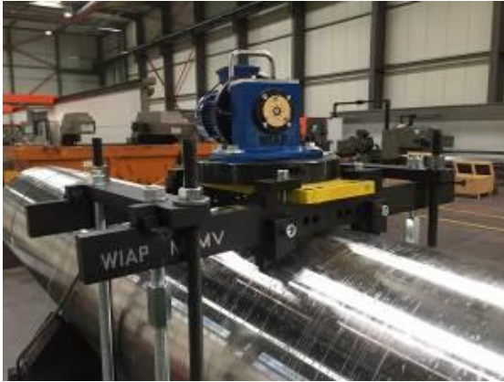
Robust jigg, som är monterad med 140 ton på komponenten. Det gör att en process pålitlig WIAP® MEMV® Avkoppling.
