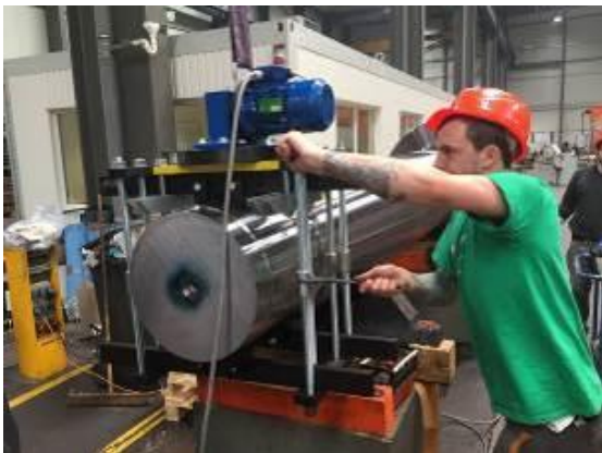
AV och DV utformad jigg; från 100 mm till 800 mm i diameter,
