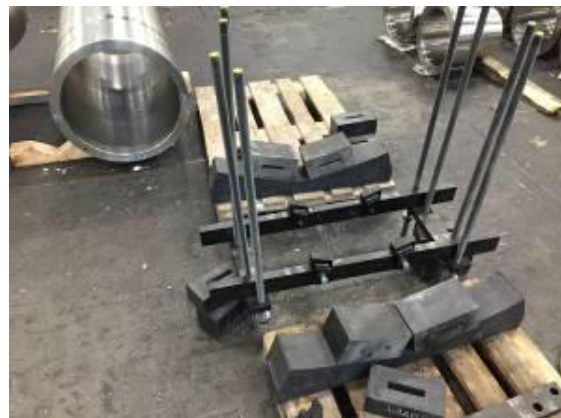
Nedre delen av rotationsförspänningsorganet
