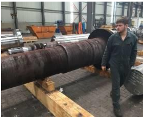
En skalad glödgade rulle. Den WIAP® MEMV® processen uppnår samma Resultat som glöd. På bilden: Sven Widmer
