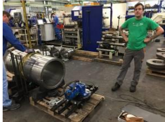
Omspänning arbetsstycket under processen av serien WIAP® MEMV® Process. Roterande skal ligger på pallan
