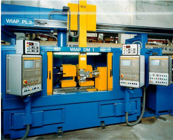
Dubbelsidig CNC-svarv WIAP® DM2 A. Två revolver. Två rörliga spindeldockor. Egen portal loader WIAP PL 2 för 2 x 7 kg Pallvikt.
