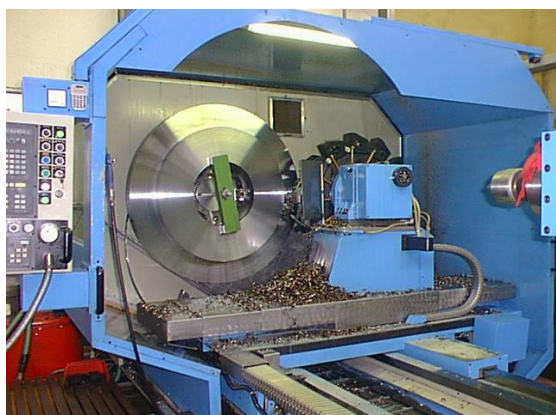
WIAP® DM4-C CNC svarv 15 Grad förklädd verktygsrevolver
