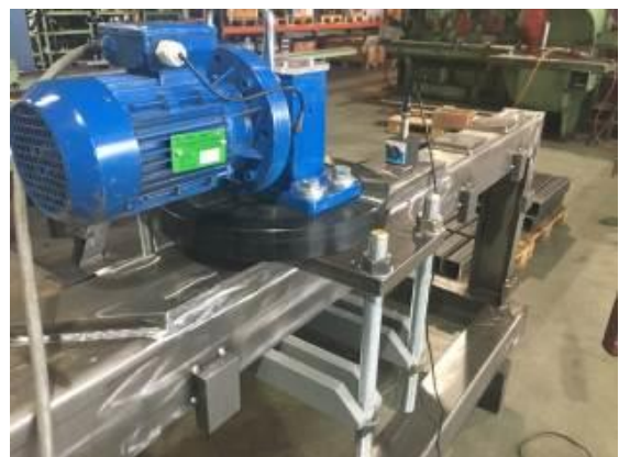
Till 15 tusen N V- exciteringsenergi kan överföras till komponenten med OV20.
