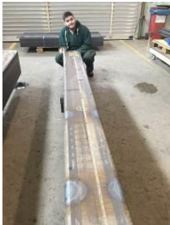
Den komponent som har ett flertal värmekroppar genom varmriktning.
