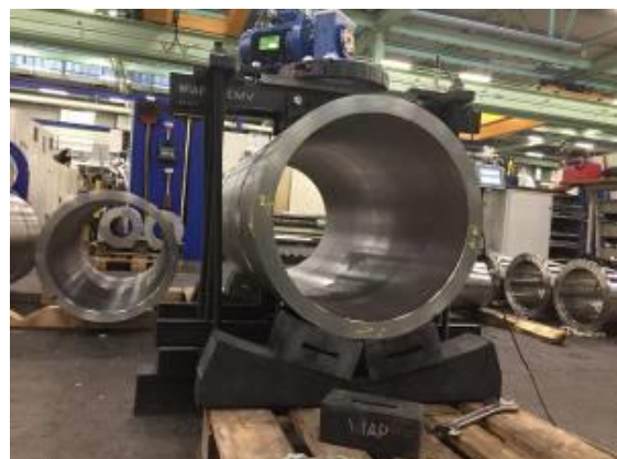
WIAP® MEMV® Process tar 3 x 12 minuter 2D, 3D och 4D; 2D = 0 °, 45 ° = 3D och 4D = 90 °
