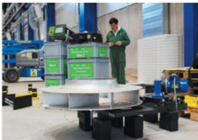
Фото 20. Рабочее колесо (импеллер) на комбинированном зажимном устройстве - август 2017 (jw)
