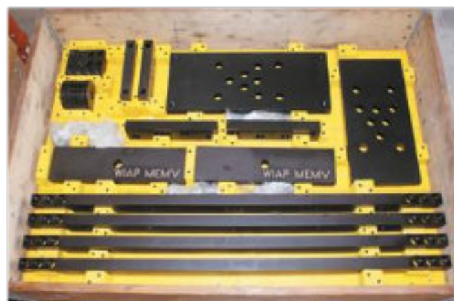
Фото 15. Зажимное устройство в осевом направлении для рабочего колеса (импеллера) - август 2017 (hrw)
