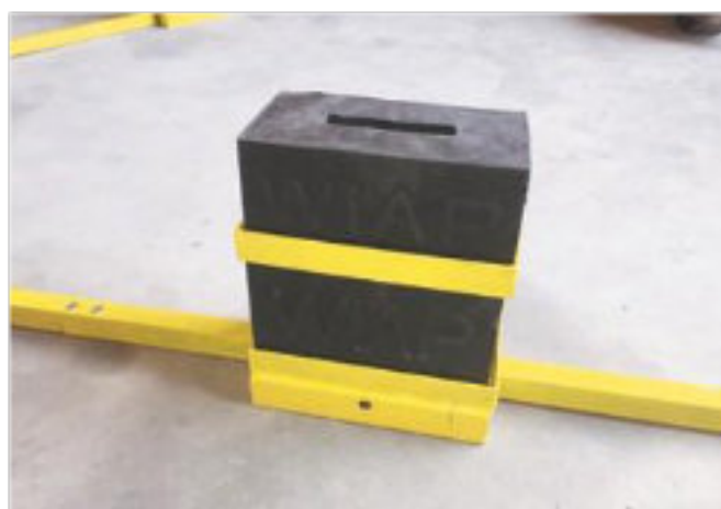
Фото 18. Резиновое половое крепление для комбинированного полового крепления - август 2017 (hrw)
