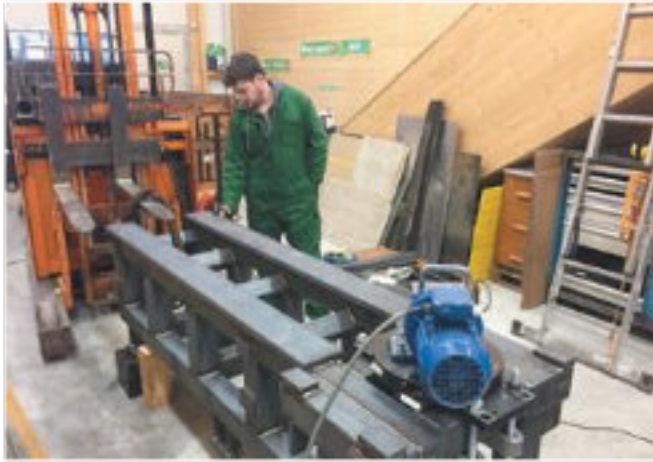
Фото 35. Снятие напряжений в раме станка WIAP DM3S с вибраций вместо отжигания. Дулликен - февраль 2018 (hrw)
