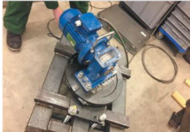
Фото 33. Снятие напряжений в опоре шпиндельной бабки. Дулликен - февраль 2018
