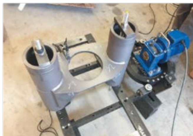
Фото 21. Комбинированное зажимное устройство, деталь клиента - октябрь 2017 (hrw)
