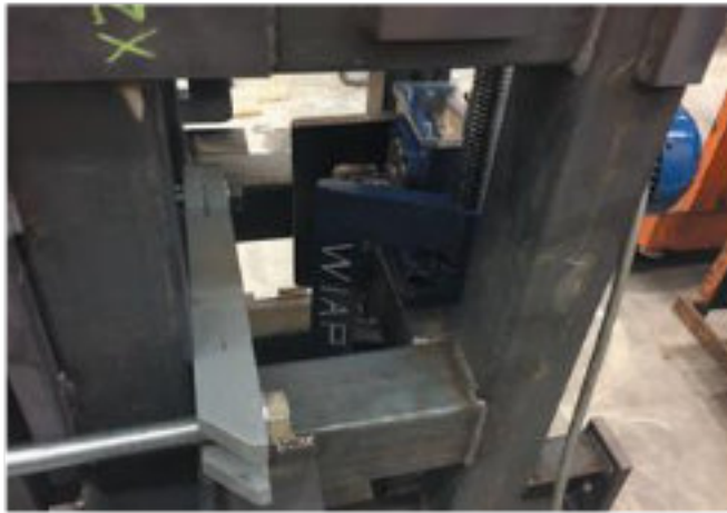
Фото 36. Применение процедуры VDSF. Рама станка DM3S, снятие напряжений с вибрацией WIAP MEMV® с демпфированной вибрацией, Дулликен - февраль 2018 (hrw)
