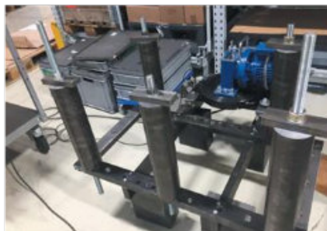
Фото 20. Шесть цилиндрических втулок на комбинированном зажимном устройстве - август 2017 (hrw)
