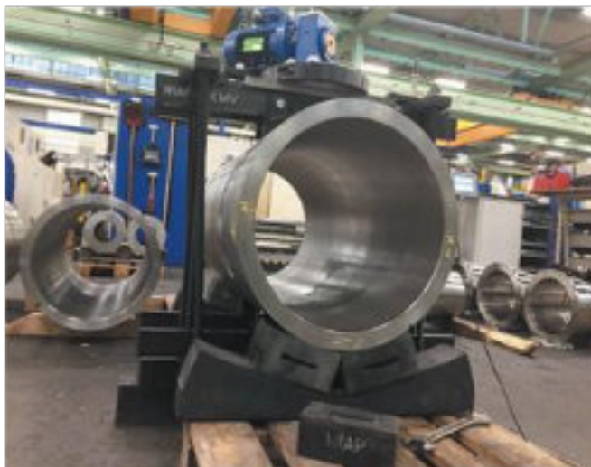
Фото 7. Испытание дуплексной трубы - август 2017 (hrw)
