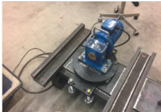
Фото 32. Многофункциональный станок WIAP CNC. DM35, снятие напряжений вибрацией MEMV®. Дулликен (hrw)
