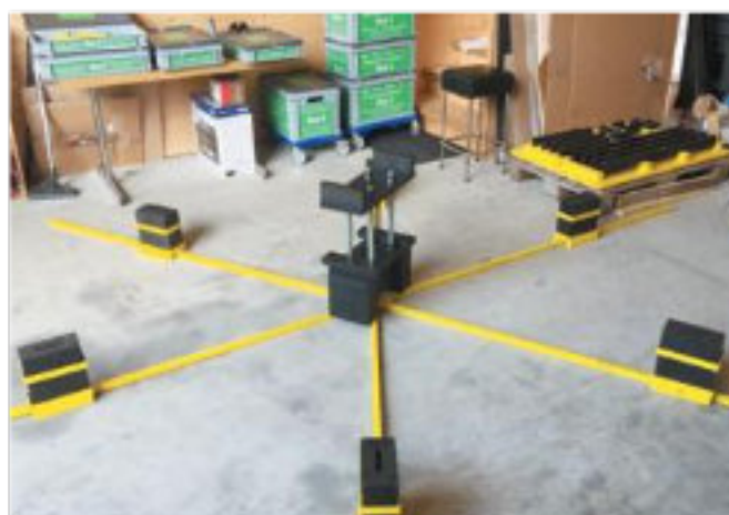
Фото 17. Резиновое половое крепление с устройством крепления для осевого возбуждения - август 2017 (hrw)
