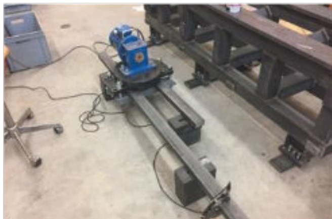
Фото 29. Закаленные направляющие. Обработка MEMV®. Дулликен - февраль 2018 (hrw)
