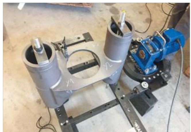
Фото 21. Комбинированное зажимное устройство, деталь клиента - октябрь 2017 (hrw)
