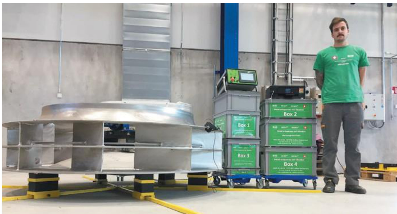
Фото 1. Джим Питер Видмер перед установкой MEMV® («Снятие напряжений в металле с помощью вибрации») фирмы WIAP AG - август 2017 г. (hpw - Hans-Peter Widmer)
