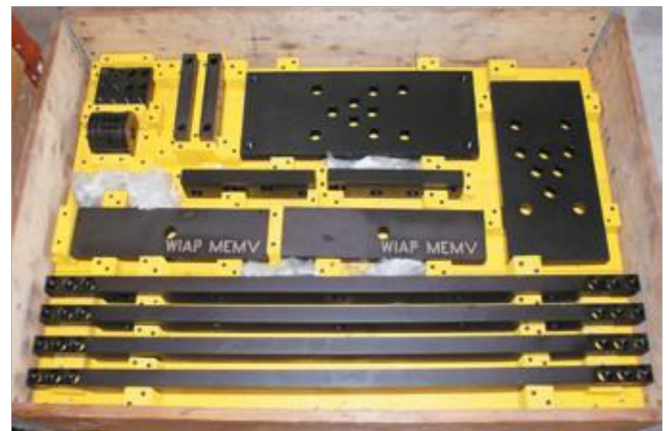
Фото 15. Зажимное устройство в осевом направлении для рабочего колеса (импеллера) - август 2017 (hrw)
