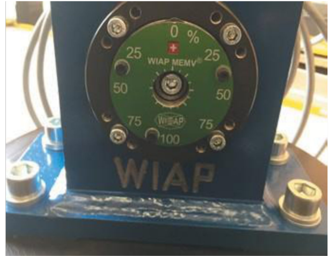
Фото 14. Новый возбудитель V20 с различными настройками в % для разных степеней эксцентрика - октябрь 2017 (hrw)
