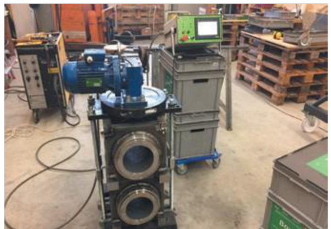
Фото 34. Двойная шпиндельная бабка, снятие напряжений с вибрацией MEMV®. Дулликен - февраль 2018 (hrw)
