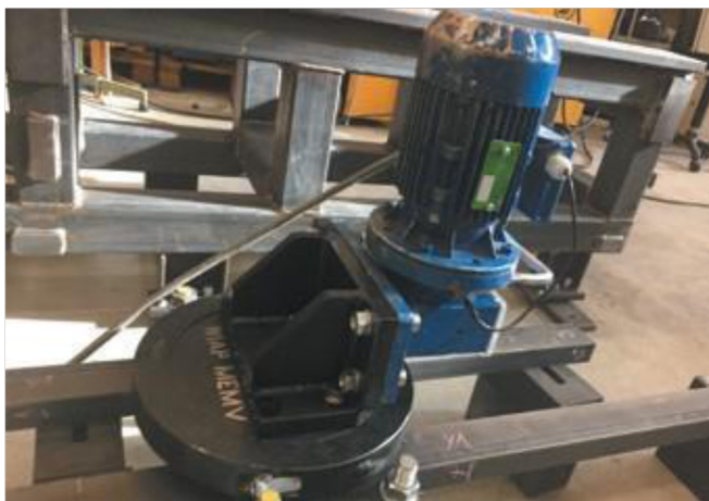
Фото 31. Снятие напряжений MEMV® в 5 осях. Дулликен - февраль 2018 (hrw)
