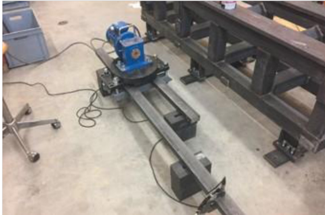
Фото 29. Закаленные направляющие. Обработка MEMV®. Дулликен - февраль 2018 (hrw)
