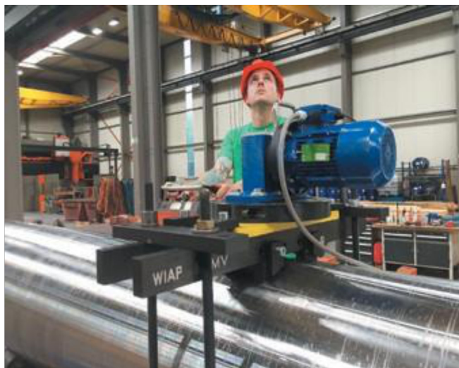
Фото 5. Вали во время снятия напряжений с помощью вибрации (MEMV®) - Джим Питер Видмер - апрель 2017 (hrw)
