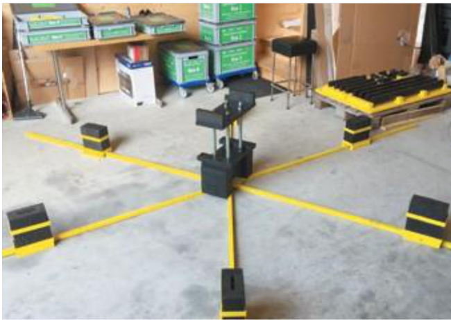
Фото 17. Резиновое половое крепление с устройством крепления для осевого возбuditеля - август 2017 (hrw)
