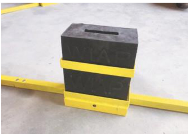
Фото 18. Резинове половое крепление для комбинированного полового крепления- август 2017 (hrw)
