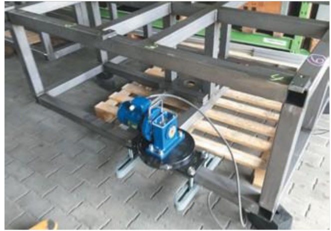
Фото 37. Снятие напряжений с вибрацией в раме, вибрирование, Восточная Швейцария - январь 2018 (hrw)
