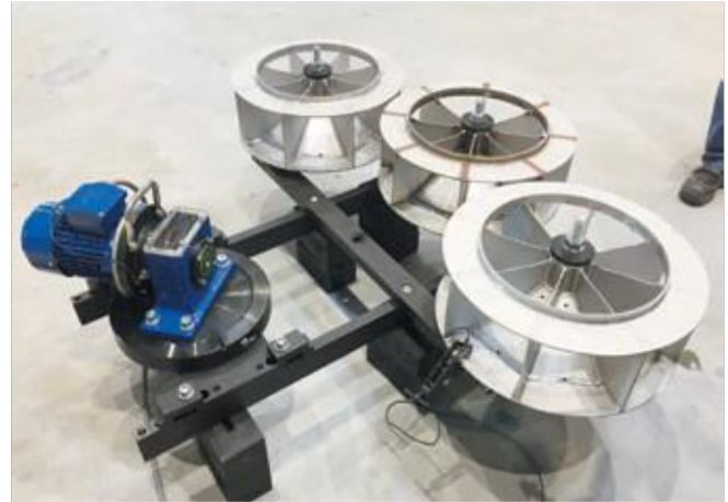
Фото 19. Три рабочих колеса (импеллеры) диаметром 800 мм на комбинированном зажимном устройстве - август 2017 (hrw)
