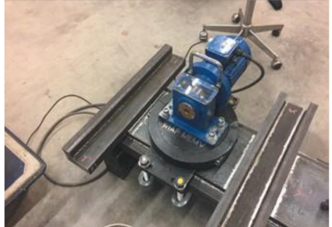
Фото 32. Многофункциональный станок WIAP CNC. DM3S, снятие напряжений вибрацией MEMV®. Дулликен (hrw)
