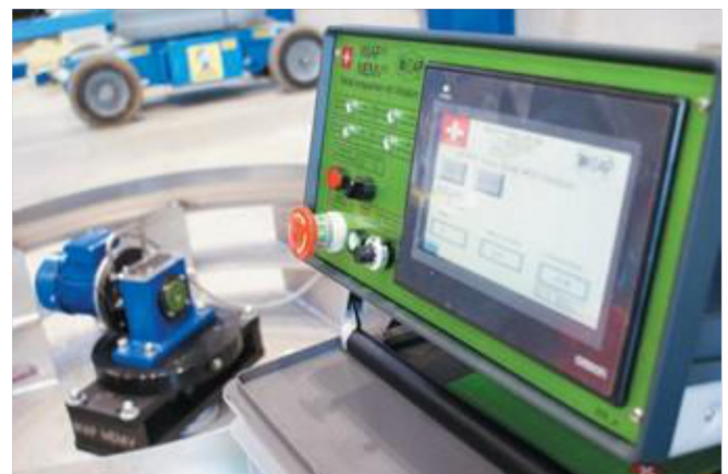
Фото 26. Блок управления WIAP MEMV® с возбудителем V20 на заднем фоне - август 2017 (jw)
