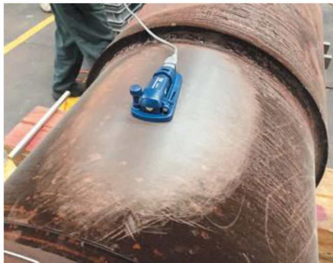
Фото 9. Тест измерения с регистратором данных: отожжённое основание - октябрь 2016 (hrw)
