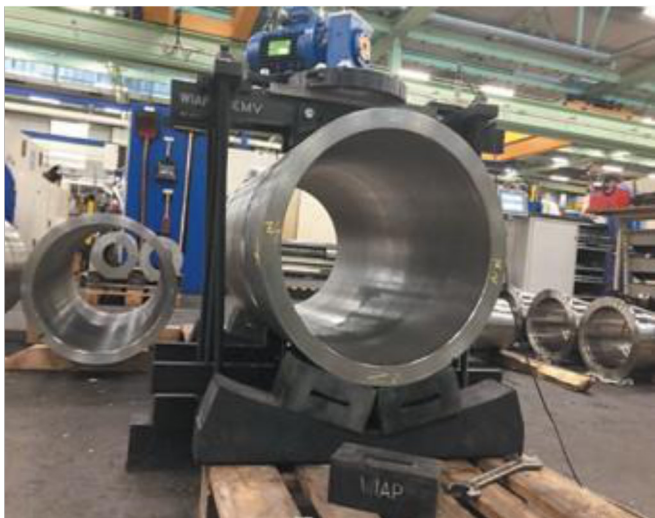
Фото 7. Испытание дуплексной трубы - август 2017 (hrw)
