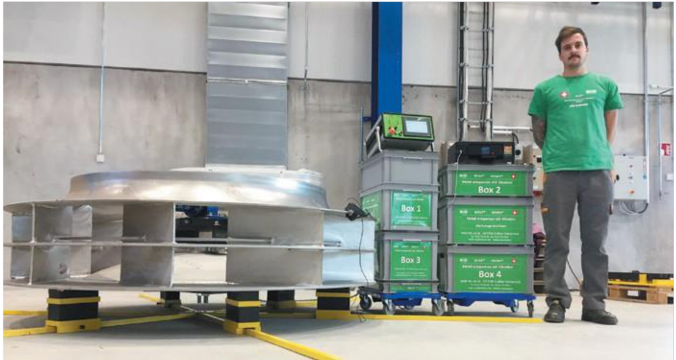
Bilde 1. Jim Peter Widmer foran et MEMV ("Avspenning av metall med vibrasjon")-anlegg fra WIAP AG - (hpw - Hans-Peter Widmer)
