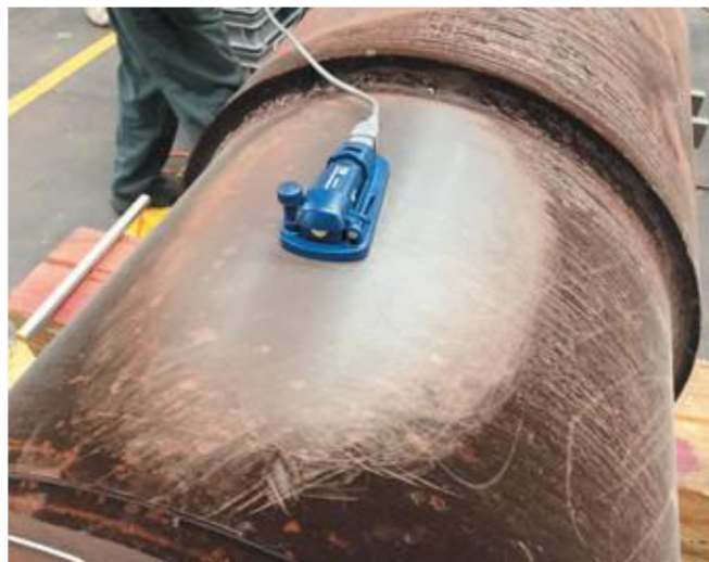
Bilde 9. Måletest med en datalogger: Støtte glødet - (hpw)
