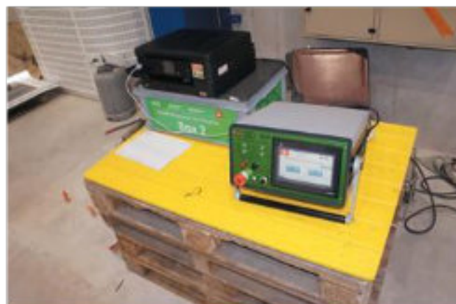
Bilde 24. Kontrollenhet WIAP MEMV med skriver og høyttalere, (jw)
