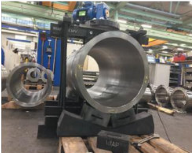
Bilde 7. Dupleks-rør-test - (hpw)
