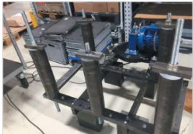
Bilde 20. Seks sylinderrør på en multi-strammeinnretning - (hpw)
