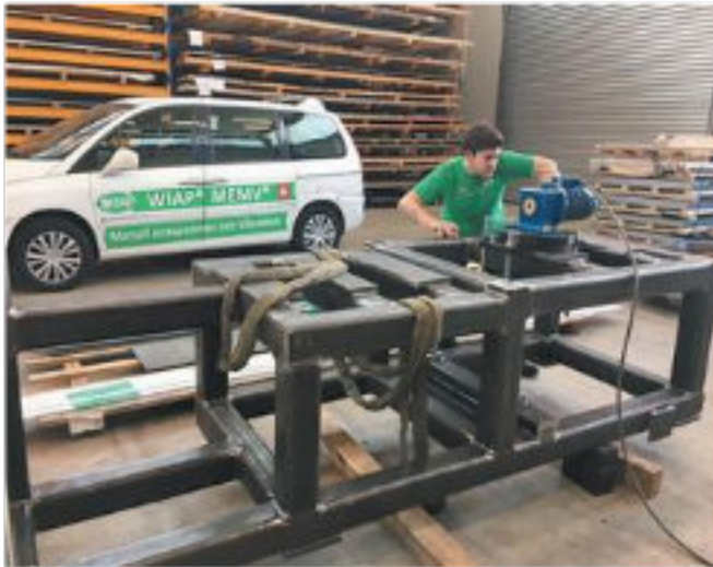
Bilde 11. Sven Widmer ved en måletest med 24 målepunkter, inkludert opprettelse av protokoll (hpw)
