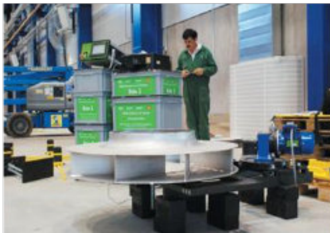
Bilde 22. Impeller på en multi-strammeinnretning - (jw)
