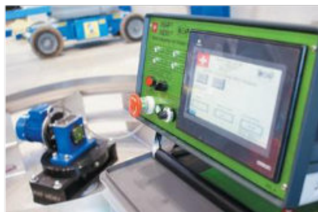
Bilde 26. Kontrollenhet WIAP MEMV med V20-aktivator i bakgrunnen, (jw)
