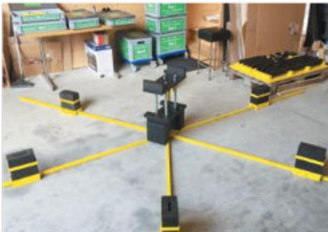
Bilde 17. Stjernegummi-bunnfeste med aksial-aktivator-festeinnretning - (hpw)
