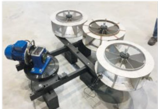
Bilde 19. Tre impellere med en diameter på 800 mm på en multi-strammeinnretning, - (hpw)
