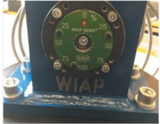
Bilde 14. Ny V20-aktivator med ulike innstillingsmuligheter i % for ulike eksentertrinn - (hpw)
