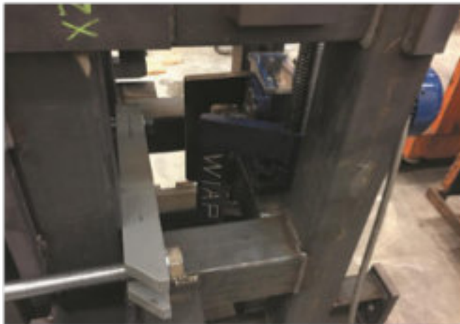
Figura 36. VDSF Applicazione di processo. DM35 Base macchina WIAP MEMV® Distensione sotto vibrazione con smorzamento di vibrazioni Dulliken - feb. 2018 hpw
