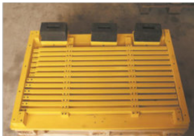
Figura 16. Fissaggio fondo a stella per supporti di gomma - agosto 2017 (jw - Jim Peter Widmer)
