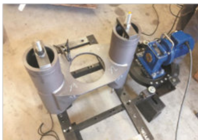
Figura 21. Dispositivo di fissaggio molteplice, parte cliente - ottobre 2017 (hpw)
