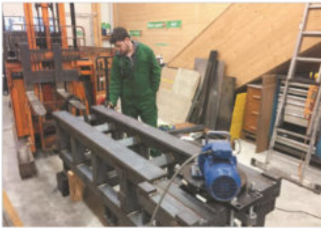
Figura 35. Base macchina WIAP DM35 distensione sotto vibrazione invece ricottura Dulliken - Feb. 2018 (hpw)
