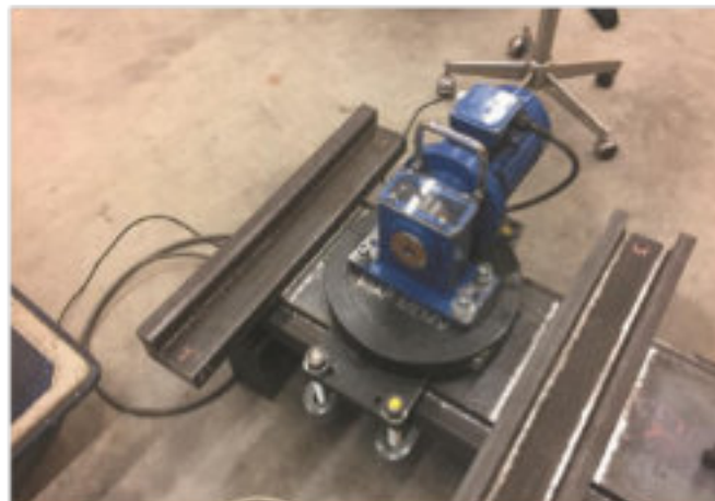
Figura 32. Macchina multifunzionale WIAP CNC. DM35 Distensione sotto vibrazione MEMV®. Dulliken (hpw)
