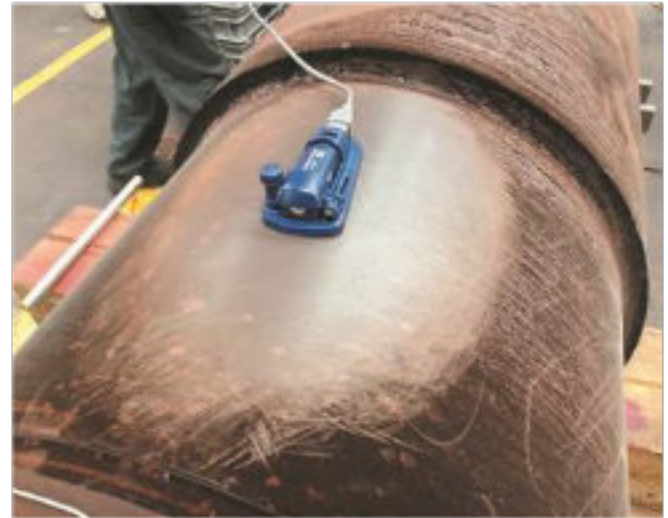
Figura 9. Prova di misura con un datalogger: supporto soggetto a ricottura - ottobre 2016 (hpw)
