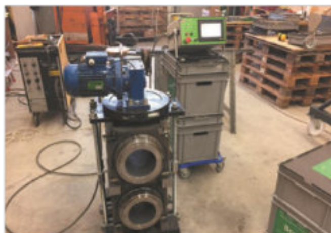
Figura 34. Distensione sotto vibrazione mandrino duplo MEMV®, Dulliken - Feb. 2018 (hpw)
