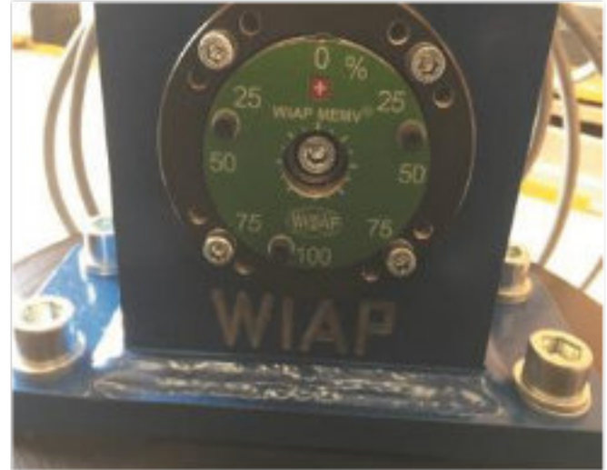
Figura 14. Nuovo eccitatore V20- con varie-Possibilità di regolazione in % per vari stadi eccentrici ottobre 2017 (hpw)
