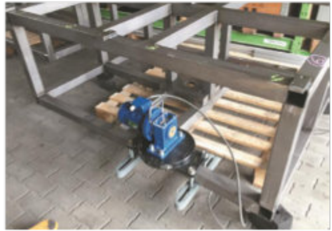
Figura 37. Distensione sotto vibrazione di telaio, vibrare, Svizzera orientale - gennaio 2018 (hpw)
