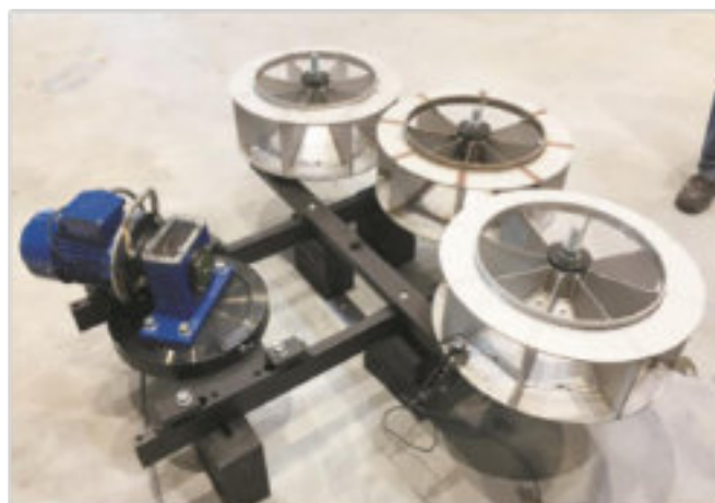
Figura 19. Tre giranti con un diametro di 800 mm in un dispositivo di fissaggio molteplice - agosto 2017 (hpw)
