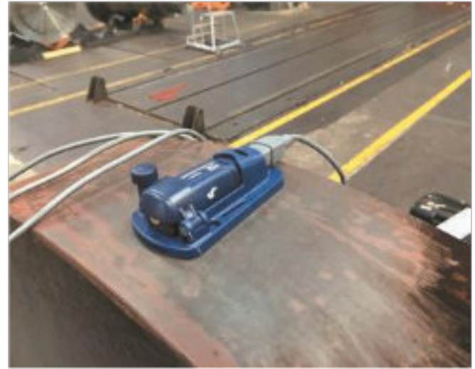
Figura 8. Prova di misura con un datalogger - ottobre 2016 (hpw)
