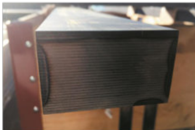
Figura 30. Indurito a laser 1 mm distensione sotto vibrazione Dulliken - feb. 2018 (hpw)
