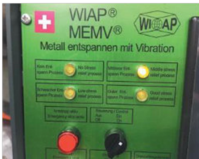
Photo N° 23 Tableau de commande WIAP-MEMV-Safenwil.
