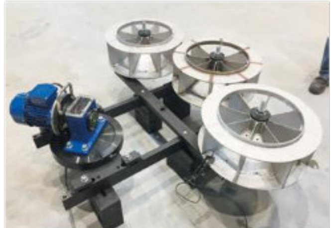
Photo N° 19 Trois roues à aubes d'un diamètre de 800 mm montées sur un gabarit multiple (Août 2017 HPW).
