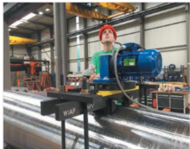
Photo N° 5 Jim Peter Widmer en train de vibrer un cylindre (Avril 2017 HPW).
