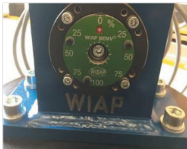
Photo N° 14 Le nouvel appareil V20 permettant de régler le stimulateur selon le pourcentage désiré (Octobre 2017 HPW).
