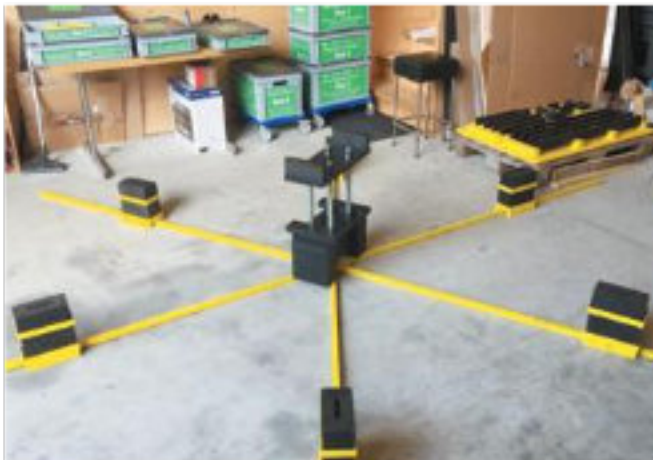
Photo N° 17 Support sur sol en caoutchouc avec dispositif de stimulation axiale (Août 2017 HPW).
