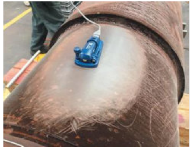
Photo N° 9 Test de mesure à l'aide d'un enregistreur de données sur une surface recuite (Octobre 2016 HPW).
