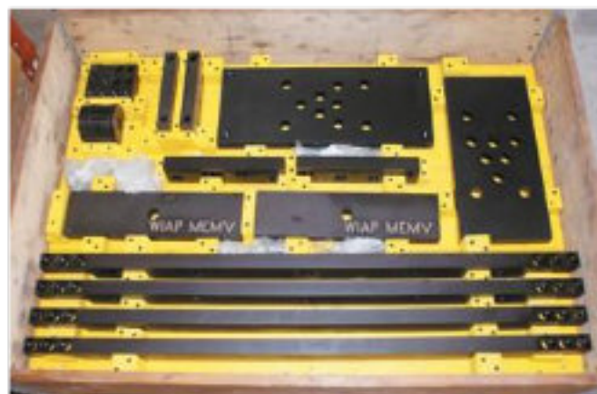
Photo N° 15 Dispositif de serrage en direction axiale pour les roues à aubes (Août 2017 HPW).
