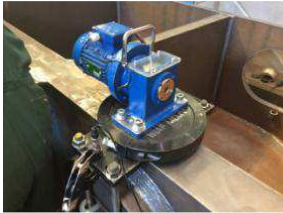
Figure 8. Le stimulateur devait être serré avec 24 tonnes sur le composant.
