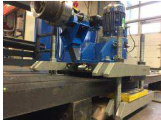
Figure 26. Un excellent set-up est crucial afin d'obtenir des mesures significatives. Ici, la matière plastique entre une partie supérieure et une plaque inférieure est fixe.
