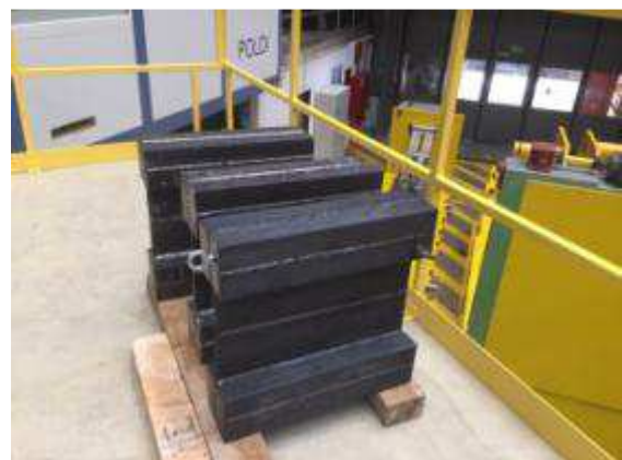
Figure 15. Trois éprouvettes en comparaison directe: recuites, composante vibriertes recuite et MEMV
