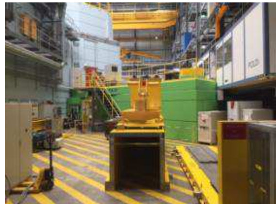
Figure 14: Mesure Poldi à l'Institut Paul Scherrer (PSI), Villigen, le 24 Octobre, 2018 détente en métal avec des vibrations (MEMV) - Test de mesure d'une pièce recuite
