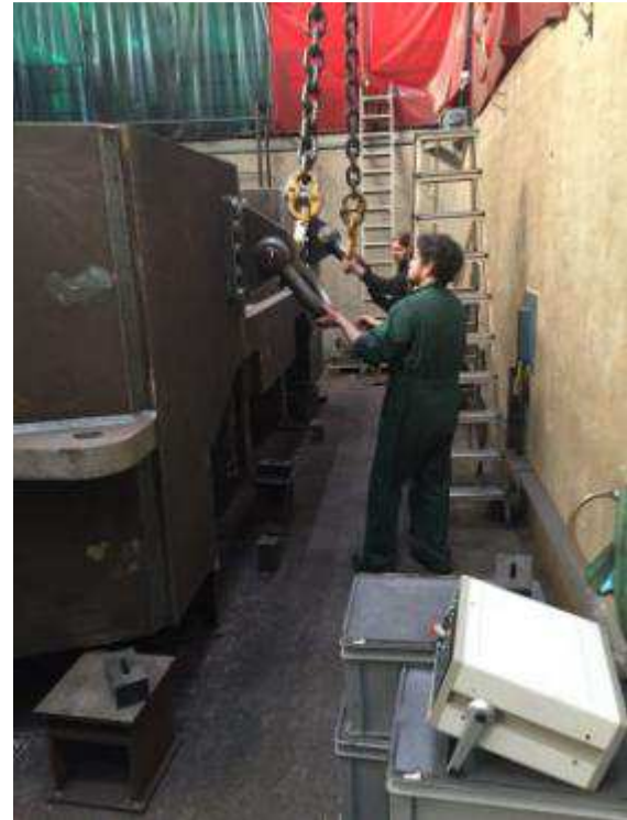
Figure 6. Une grue soulève la pièce de 60 tonnes et la place sur un coussin en caoutchouc pour transférer des suggestions dans la salle pendant la vibration.
