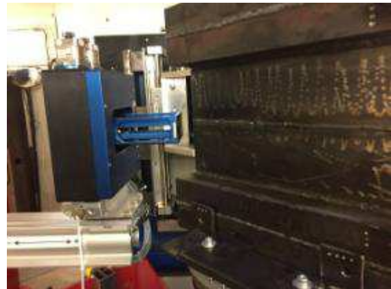
Figure 18. Le système de test peut mesurer jusqu'à une épaisseur de paroi de 15 mm.
