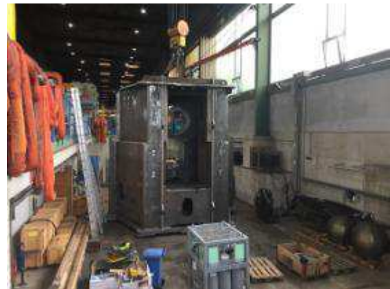
Figure 11. En peu de temps le composant 120 tonnes a été excité par une vibration fixe permanent, à différentes zones spécifiquement localisées. Ceci est seulement possible avec une tension robuste et un puissant stimulateur. Ce projet majeur de composants a montré comment peut agir un dispositif extrêmement puissant de vibrations sur les composants.
