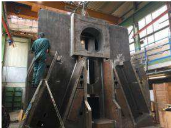
Figure 9. composant 120 tonnes dans la phase de préparation avant la MEMV détendre: ce composant a également été mis sur des patins en caoutchouc et le stimulateur fixé avec 24 tonnes de force de la part.
