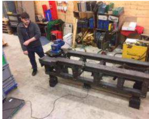
Figure 2. lit de la machine de la nouvelle machine brunissage à rouleaux et alésage WIAP DM3S
