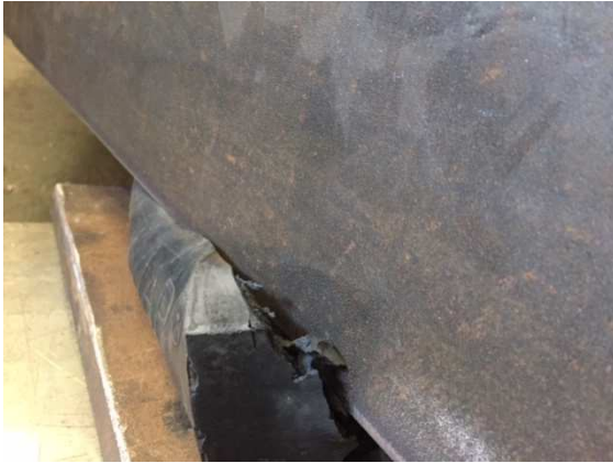
Figure 8: Ici, la surface inégale a débordé le caoutchouc, même si nous avons beaucoup de caoutchouc. Si un travail est plus profond quand il est abaissé, elle dépasse la limite d'élasticité du caoutchouc et endommagé, il nous devons parce que le caoutchouc plus grande échelle insérer ici sous les plaques métalliques de support.
