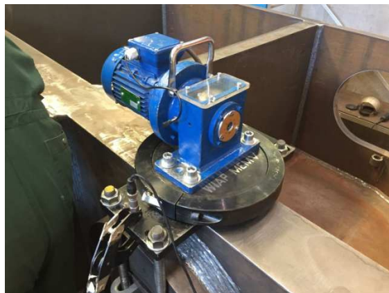
Figure 9: Le stimulateur WIAP V doit être bien fixé. Si le composant est déplacé dans la zone de résonance, vous pensez que vous assis dans une guitare. Un, grand bruit très intense. Fréquemment 90dB être dépassée. Cependant, un bon serrage est, si le composant se déplace à 50G, mais presque pas de dB peut être vu.
