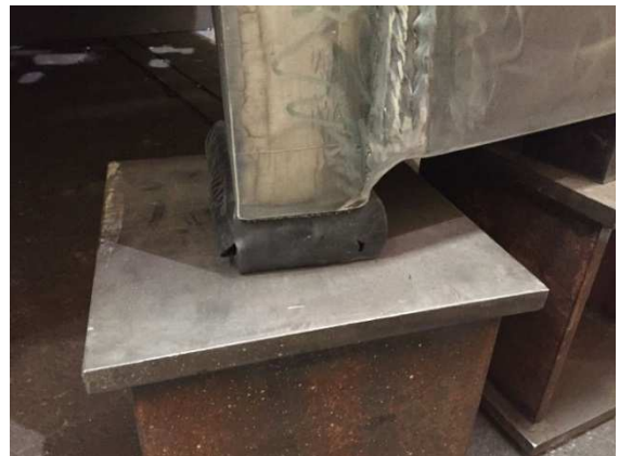
Figure 7: C'est là que 60% de l'hématome en caoutchouc a été atteint, plus doit être évitée.
