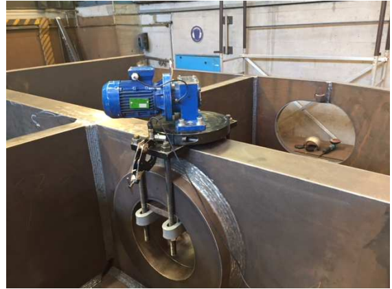
Figure 7: Le vibreur WIAP V a été monté dans un emplacement avec une plus grande élasticité. Pincettes tiennent beaucoup trop peu.
