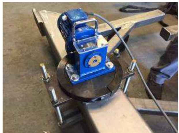
Figure 2: racks pour un constructeur d'avions. Ceux-ci sont traités MEMV, qui vibre. (Photo HP)
