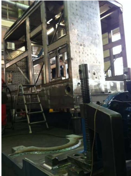
Figure 7: Ici, le châssis MEMV être traité pour l'une des locomotives à vapeur les plus puissants du monde. Conçu pour le Brésil. Vibration Relaxed (sw photo)
