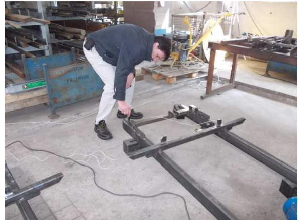
Figure 1: châssis de véhicule pour l'un des plus grand constructeur automobile allemand. Les rejets en arrière dans l'usine de recuit à l'état initial avant de se redresser. (Photo HP)
