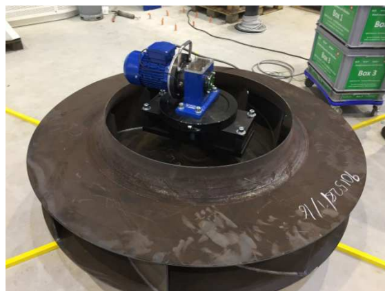
Figure 21: Voici une roue à aubes recuits WIAP® MEMV® traitée afin de faire des mesures comparatives, comme pour les rouleaux lourds, de sorte que les mesures peuvent être détectées. En rendant compte de la différence des composants recuits et non recuits.
