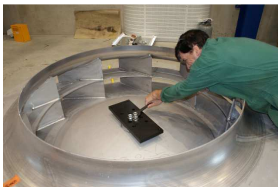
Figure 6: Un serrage solide du dispositif de serrage axial garantit un métal sans erreur se détendre avec vibration. Juste un bon set-up permet également de bons résultats.
