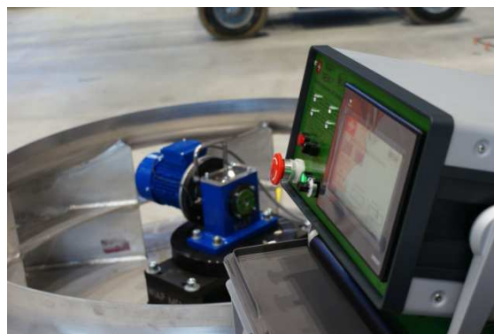
Figure 12: Le entièrement automatique WIAP® MEMV® Unité de commande avec le type vibreur V arrière V20.
