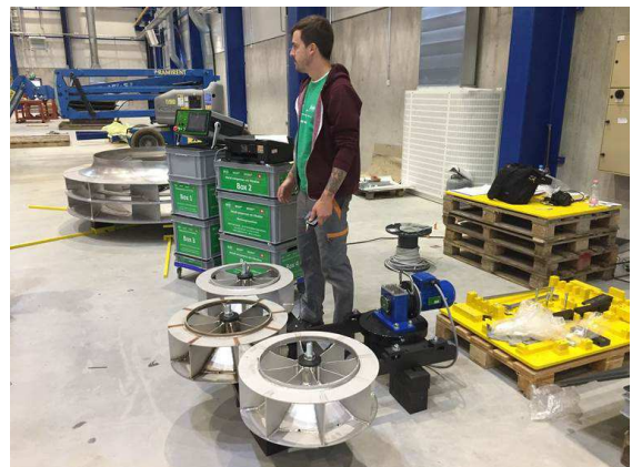
Figure 18: 3 Impeller diamètre 500 mm sur le WIAP Mehrfachaufspannvorrichtung. Avec la mesure multi-point pour l'enregistrement. Dispositif pour l'enregistrement.
