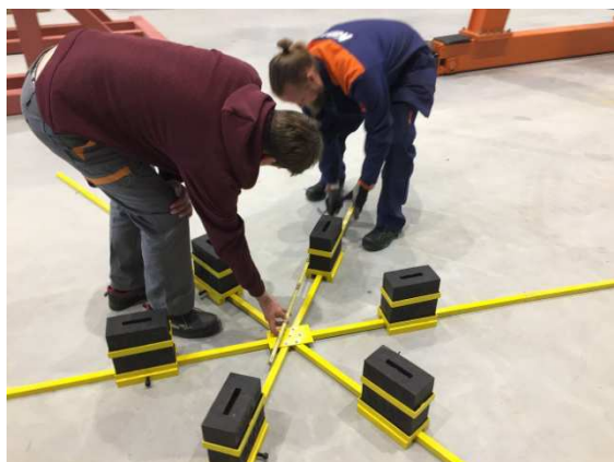
Figure 5: WIAP® MEMV®6 Dispositif Sternaufiage- est dans les positions du support de diamètre 1300 mm; définir. On évite ainsi que les tampons en caoutchouc peuvent migrer à distance les mouvements de résonance. Si besoin est, que les opérateurs ne se renverse pas lors de l'entrée de la roue. Le diamètre extérieur de la roue était de 1500 mm; le caoutchouc est fixé dans un rayon de 650 mm.
