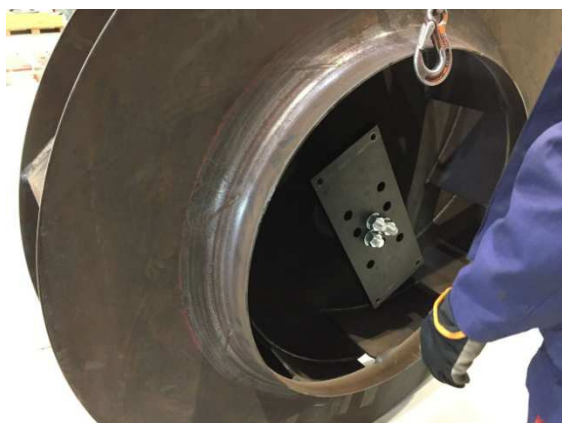
Figure 20: Fixation du dispositif de serrage axial, de sorte que le moyeu étoile de l'intérieur, et non pas l'extérieur peut être excité indirectement. L'attachement est si bon que plusieurs tonnes d'excitation peuvent être amenés dans le composant sans erreurs.
