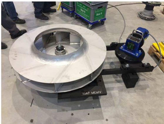
Figure 15: Roue spéciale; Matériel duplex sur Mehrfachaufspannvorrichtung; il est détendu dans 4 directions.
