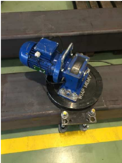
Figure 12: Ici, le stimulateur est réglé pour l'excitation de X / Y et l'axe Z, par exemple l'agencement de direction de l'axe de 45 °
