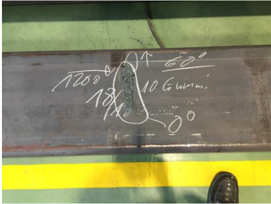
Figure 4: Le premier point de neutralisation est à 1200mm
