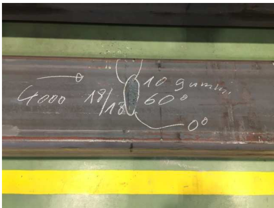
Figure 5: Le deuxième point de neutralisation est à 4000mm
