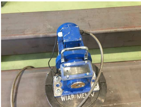
Figure 13: Ici, le stimulateur est réglé pour l'excitation de l'axe Y et Z, par exemple l'agencement de 0 °, nous donnons ici aucune énergie d'excitation dans l'axe X. Ce qui est rapporté selon le protocole.
