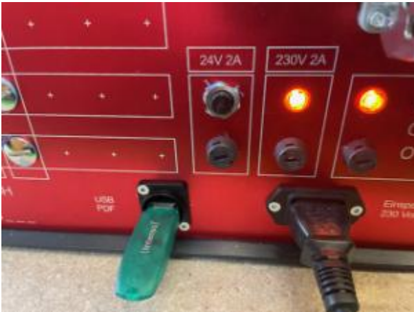
Bild 7.3 Steuergerät von hinten Strom Anschluss Und USB Anschluss
