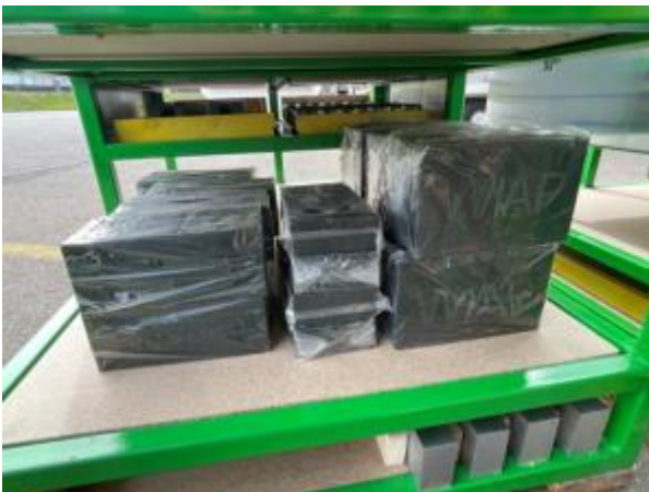
Bild 5.13 8 Stk. Gummi 100x120x200, 8 Stk. Gummi 80x100x200; 4 Stk. Gummi 40x100x200; ermöglichen immer 1 Teil zu entspannen und das 2. Teil vorzubereiten.
