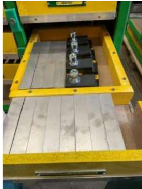
Bild 5.8 4 Stk. 4 Locheisen 30x50x250, 8 Stk. 3 Locheisen 30x50x150. 4 Spannriden für die Langeisenbefestigung
