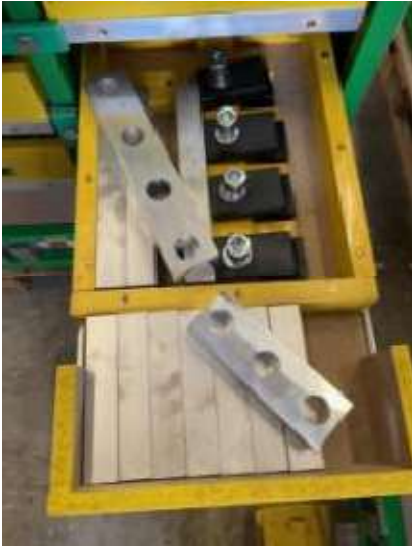
Bild 11.1 4 Stk. 4 Locheisen und 8 Stk. 3 Locheisen ermöglichen auch eine Eckspannung
