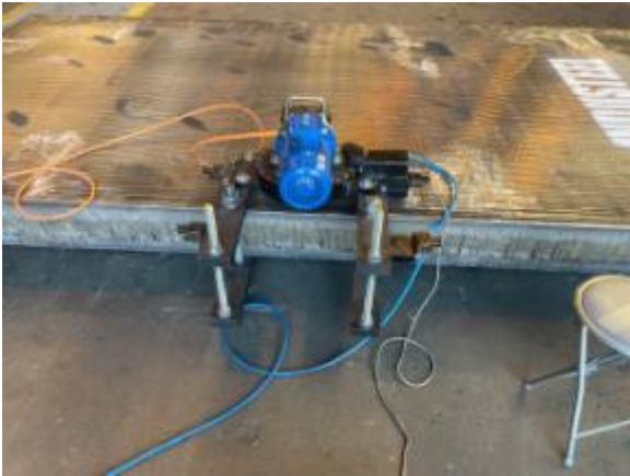
Bild 12.1 ADP MEMV Gerät aufgebaut an grosser Stahlplatte, Masse 200x2300 x14000
