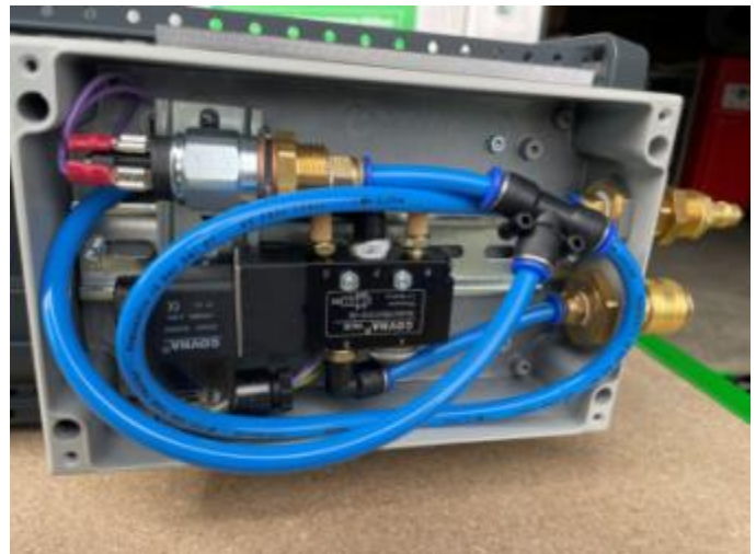
Bild 7.2 Die Drehautomatik wird Pneumatisch versorgt
