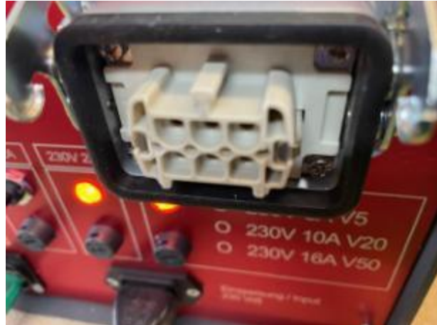
Bild 7.4 Anreger Motor Anschluss am Steuergerät
