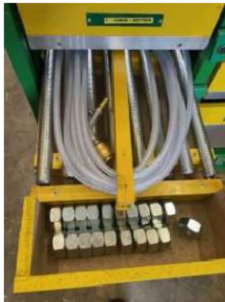
Bild 8.4 Der Luftschlauch Steuergerät zur Drehvorrichtung Wird bei den Gewindestangen Deponiert.
