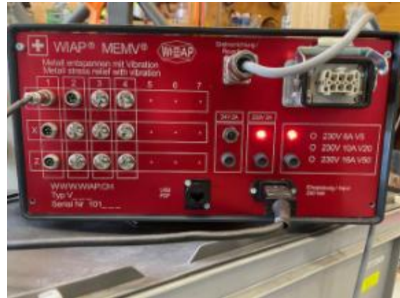
Bild 4.2 Steuergerät von hinten; vorbereitet für 12 Sonden, USB, Signalstecker zu Drehautomat. Motor.
