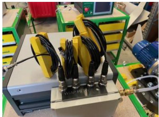
Bild 9.2 Für den Umspannprozess können die Sonden parkiert werden am Steuergerät
