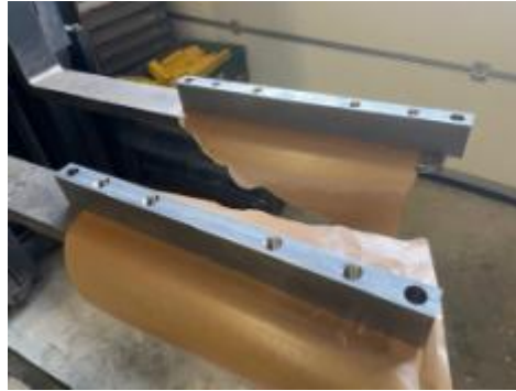
Bild 11.2 der Anreger kann auf die Unterplatte Eisen 640 mm gestellt werden. Längs oder auch quer.
