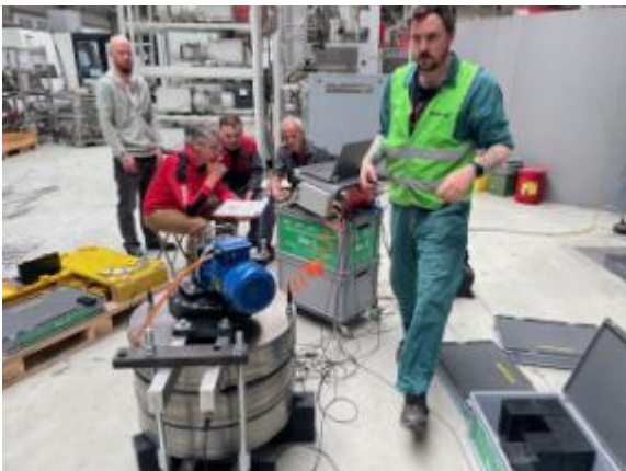
Bild 12.3 ADP MEMV Gerät aufgebaut bei kleinen Bauteilen
