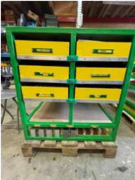
Bild 6.1 Das Transportgestell soll beim Verfahren mit dem Palettenwagen oder der Fracht mit Kran, immer gesichert werden.
