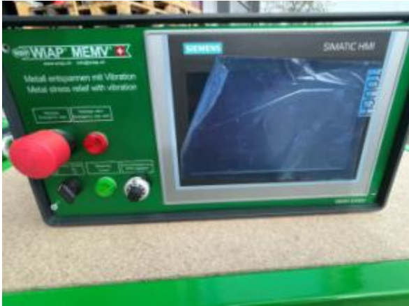
Bild 4.1 Ansicht Steuergerät von vorne; beinhaltet alle nötige Software für ein gutes Entspannen mit dem MEMV Verfahren
