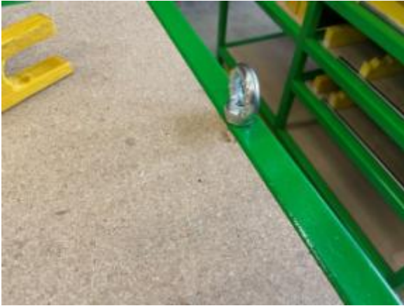
Bild 6.3 4 Ringschrauben; jede für 230 kg vereinfachen das Transportieren
