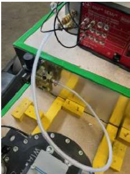
Bild. 8.3 Luftanschluss ab der Wartungseinheit
