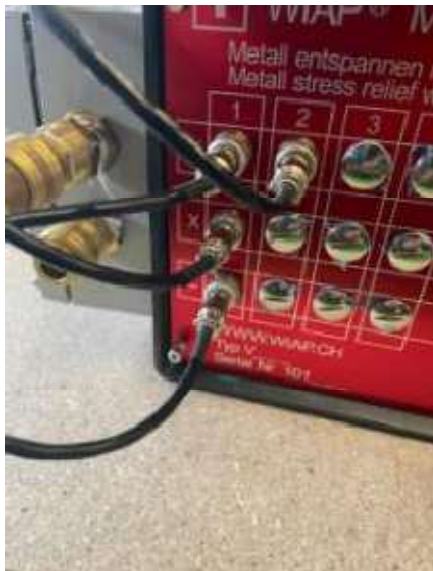
Bild 9.1 Bis 21 Sonden können an dem Steuergerät angeschlossen werden Wir haben jetzt in der Version 4
