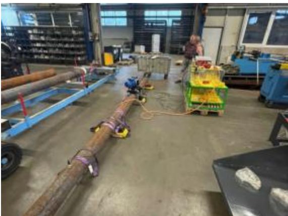
Bild 12.5 Wellen werden MEMV entspannt
