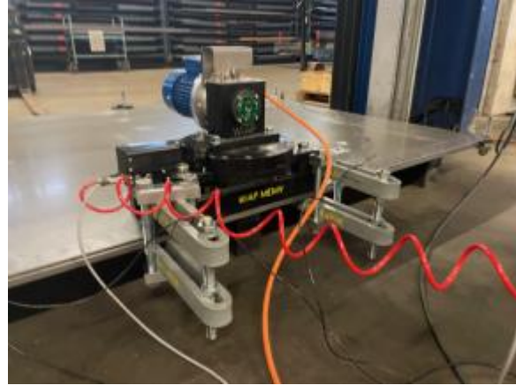
Bild 12.8 das bewährte Wiap Seitenklemm System
