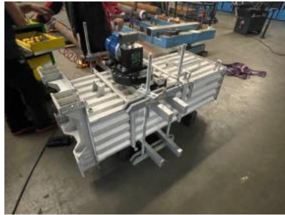
Bild 12.10 30 Kg Alu Behälter wird MEMV entspannt
