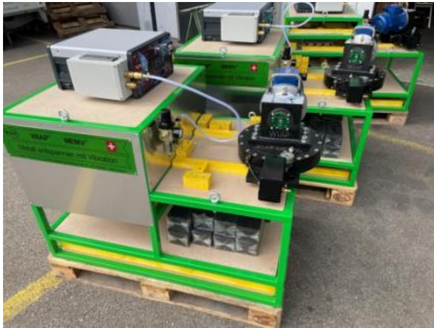
Bild 1: Ansicht des ADP Gestell für die MEMV Anlage WIAP mit dem Anreger V20
