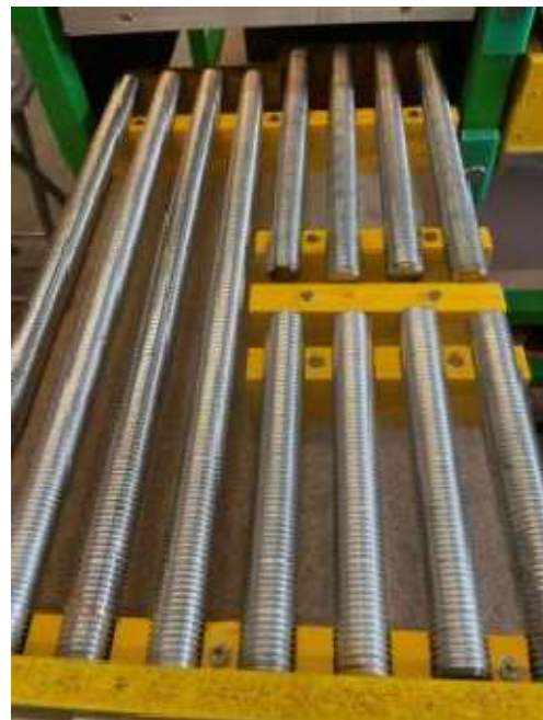
Bild 5.10 Gewindestangen 500x300 und 200 Lang sorgen für ein gutes Aufspannen
