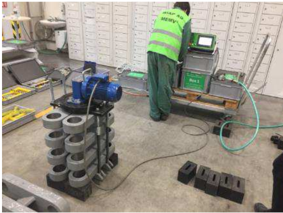
Bild: WM 865_40. Künstlich altern von Gussteilen.
