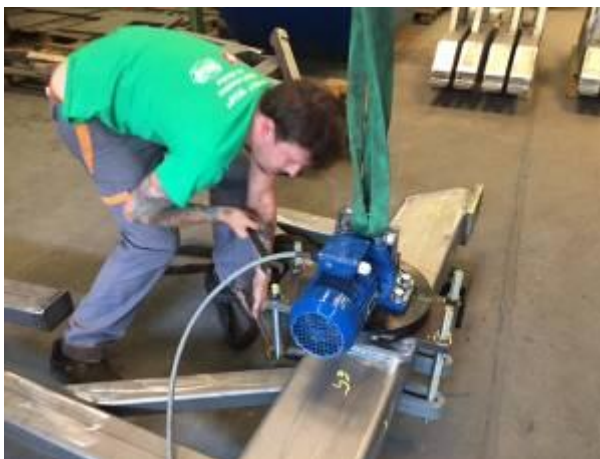
Bild 4: Das gute Befestigen ist wichtig, um die G Anregung auch im Griff zu haben, resp. richtig messen zu können. (Foto hp)
