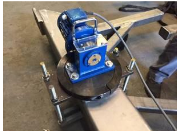
Bild 2: Gestelle für ein Flugzeugbauer. Diese werden MEMV behandelt, also vibriert. (Foto hp)
