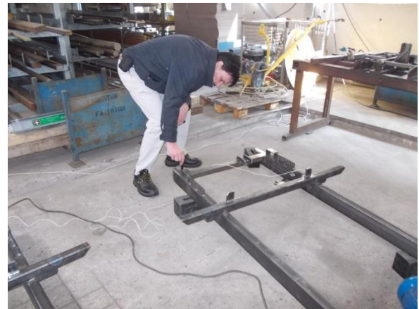
Bild 1: Fahrzeuguntergestell für einer der grössten deutschen Autobauer. Die verwirft es in der Glüherei in den Zustand zurück, wie vor dem Richten. (Foto hp)
