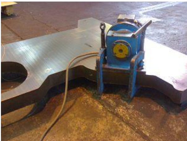
Фото 8: У підготовлених плитах перед кінцевою обробкою напруження знімаються вібрацією.
