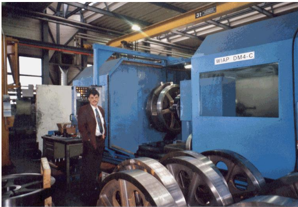
Фото 16б: Багато таких CNC Wiap DM4C, 24 тонних, токарних станків виготовив Wiap для Анголи та Швейцарії. Напруження у всіх машин знімаються вібрацією.
