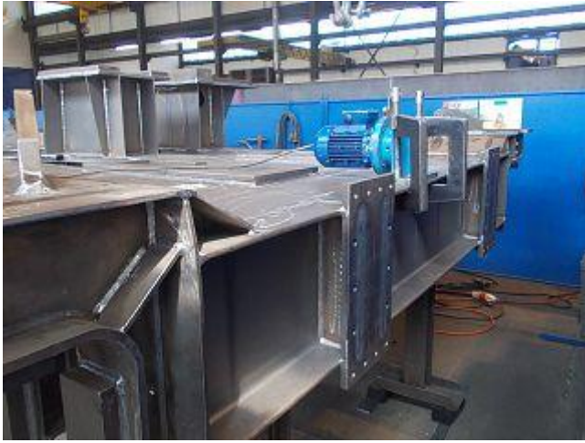
Фото 10: Тонкостінні конструкції можуть за допомогою незначних зусиль дуже сильно коливатися. Завдяки рівномірному, одночасному встановленні вібратора через збудник V одночасно знімаються і всі напруження.
