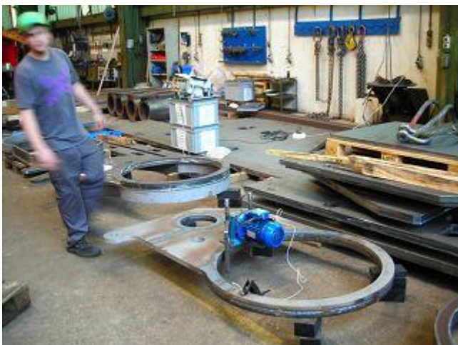
Фото 11. У вигорілих кільцях перед обробкою напруження знімаються вібрацією
