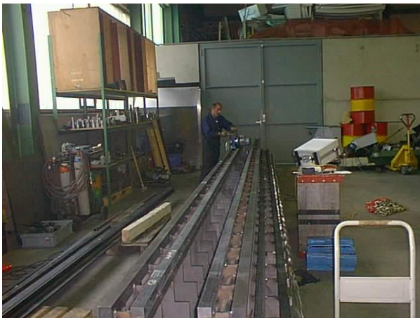
Фото16а. У 12 м станини із 8 направляючими напруження також знімаються вібрацією.
