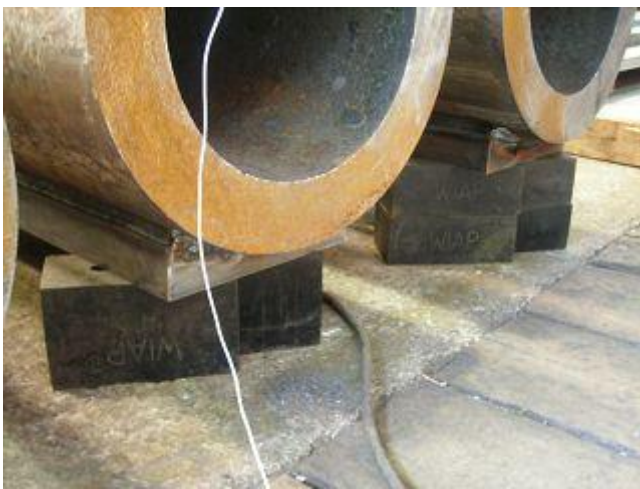
Фото 13: Кожна деталь повинна лежати на резині, для того щоб жодне коливання не передавалося по приміщенню.
