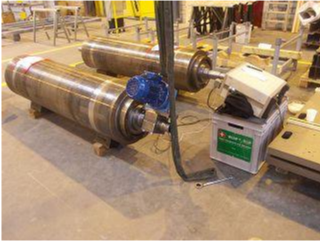
Фото 5: У виробника валів без зняття напружень вібрацією утворюються викривлення у багато десятих мм, перш за все після твердого хромування. Якщо б напруження знімалися вібрацією, то викривлення можна було б зменшити у багато разів.
