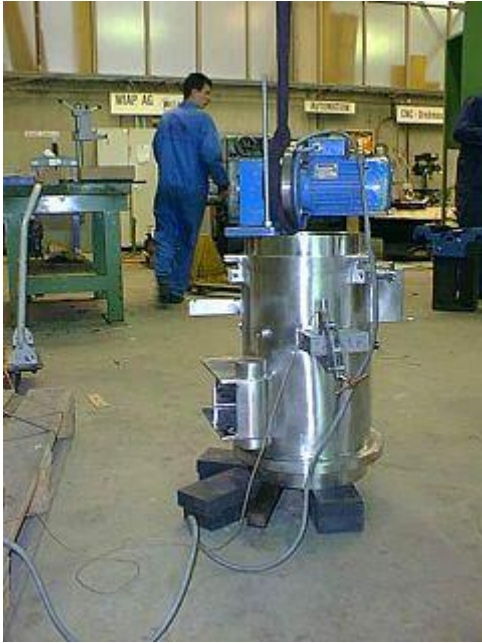
Фото 4: Зняття напружень вібрацією у багатьох нержавіючих баках. Спеціалісти, які займаються обробкою, кажуть, що у деталей, напруження у яких було знято вібрацією, не мають викривлення і це не заважає подальшій обробці.
