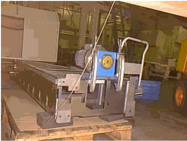
Фото 13а. Зняття напружень із станини вібрацією для іншого клієнта
