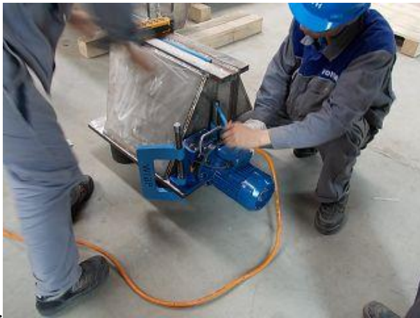
Фото 3: На фірмі Voith China напруження знімаються вібрацією у всіх деталей.
