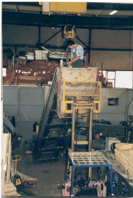
Фото 16в: Після зняття напружень вібрацією станини заповнюються наповнювачем, для того щоб вони стали важкими і не вібрували.
