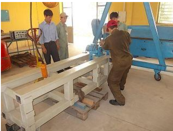
Фото 14: Тут знімаються напруження вібрацією у каркасі токарного станка
