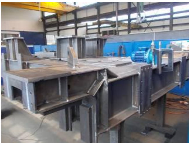
Фото 6): Также в каретке крана напряжения снимаются вибрацией. (Фото, Швейцария 2012 hrw)
