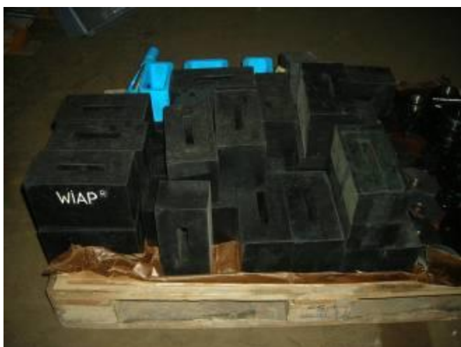
Фото 17): Здесь видно резиновые подкладки. WIAP использует 80 x 100 x 200 и 120 x 100 x 200 мм. Важно, чтоб было хорошее приглушение и не вибрировал цех. (Фото, Швейцария 2012 hpw)
