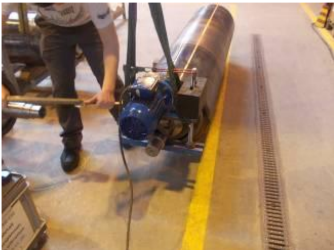
Фото 5): У многих таких валов напряжения снимаются вибрацией (Фото, Швейцария, 2012 hrw)
