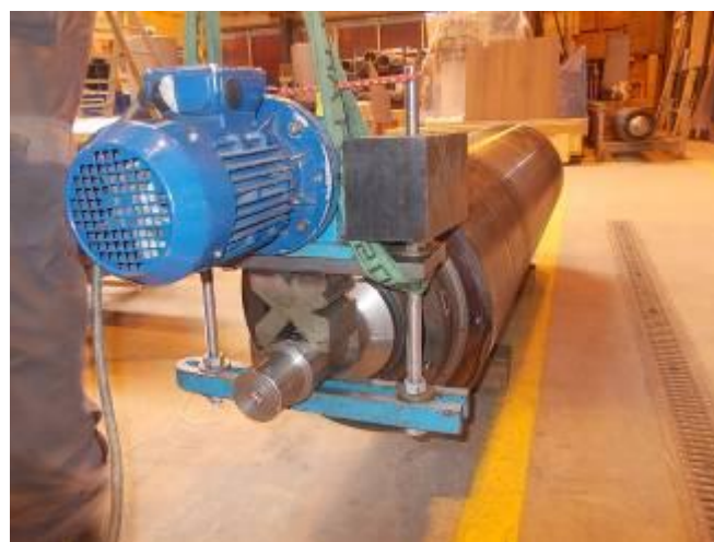
Фото 4): Эти валы используются у тысячной мм после хромирования. После отжигания, потом хромирования
