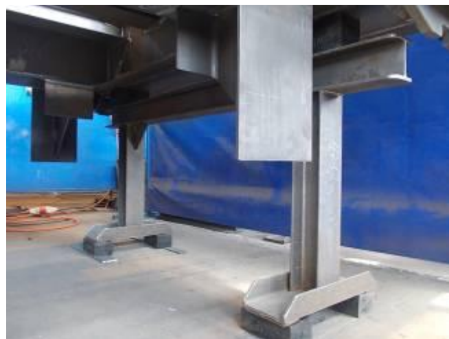
Фото 7). Без этих резиновых подкладок нельзя снять напряжение вибрацией ни в одной детали. (Фото, Швейцария 2012 hrw )
