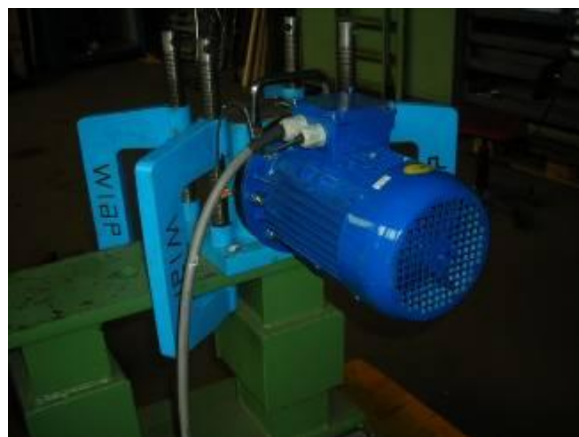
Фото 2): Эта установка LC 50 имеет двигатель 2.2 KW; 400 Volt 100 Hz. Вибратор крепится с помощью тяжёлых струбцин WIAP.
