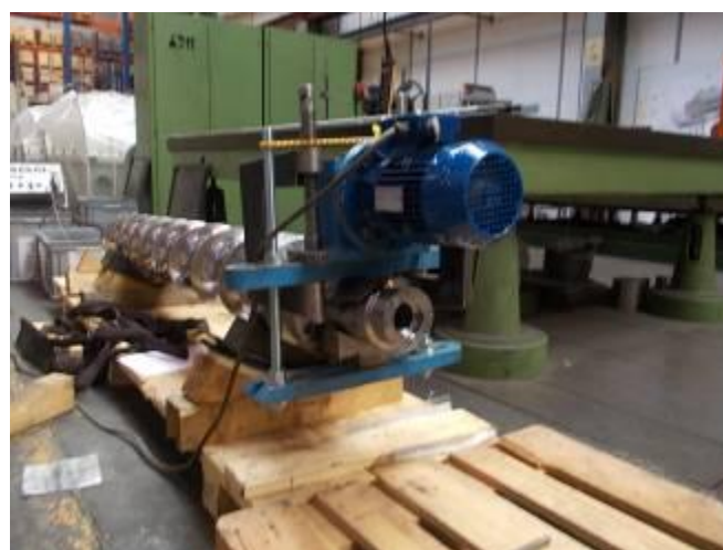
Фото 9): Напряжения у червячных валах уже десятилетия как снимаются с помощью установки WIAP LC (Фото, Швейцария 2012 hrw)
