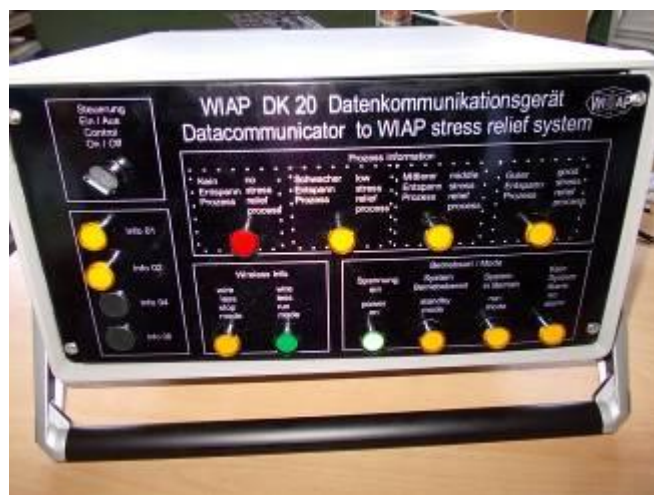
Фото 14): Новое устройство для передачи данных WIAP DK20 обеспечивает передачу данных через wireless на ноутбук (Фото, Швейцария CH 2012 hrw)
