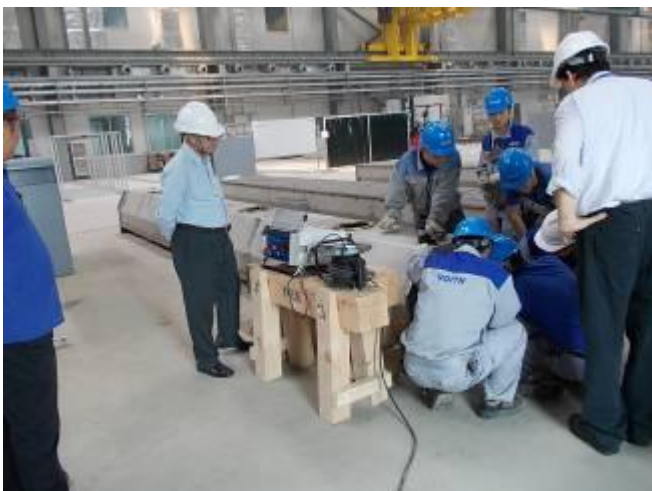
Фото 12): В 2012 году одна установка WIAP LC 20 была отправлена в Китай. Эта установка снимает напряжения
