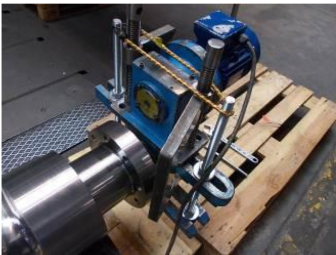
Фото 10): Для зажима вибратора нужно прочное устройство (Фото, Швейцария ch 2012 hrw)
