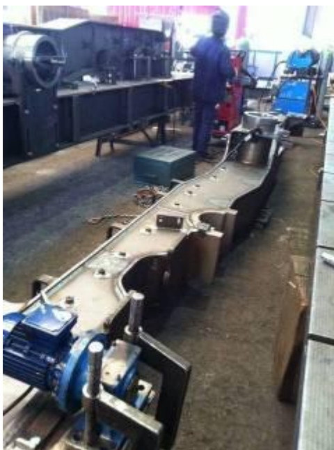
Фото 11): Также у деталей для транспортных средств напряжения снимаются вибрацией (Фото, 2012 Швейцария hrw)
