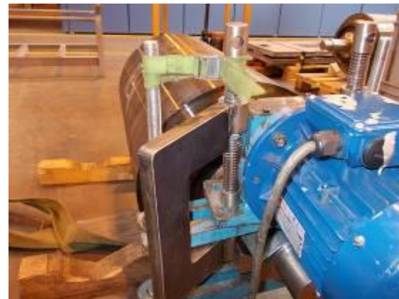
Фото 3.С помощью прочных струбцин WIAP нужно соединить деталь с вибратором.
