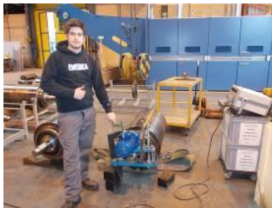
Фото 1.Свен Видмер во время вибрационного снятия напряжений. Много клиентов регулярно заказывают снятие напряжений в металле. Это хорошая замена отжиганию. Стоим меньше и экономит много энергии.
