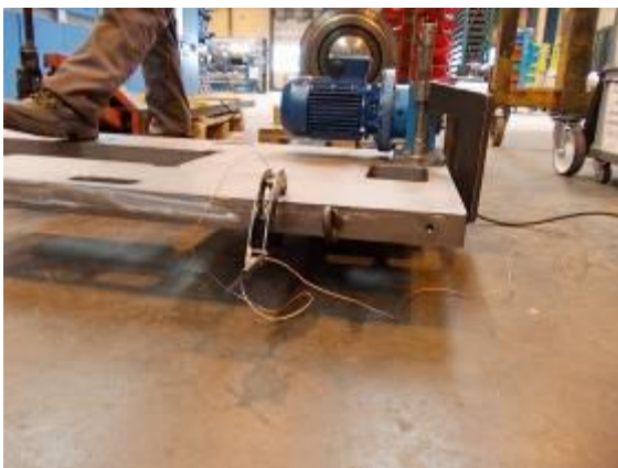
Фото 5: Также сгоревшие плиты, которые без вибрирования искривляются на мм, благодаря вибрации остаются искривлёнными на несколько десятых мм. То есть вибрационное снятие напряжений в металле есть альтернативой к отжиганию.
