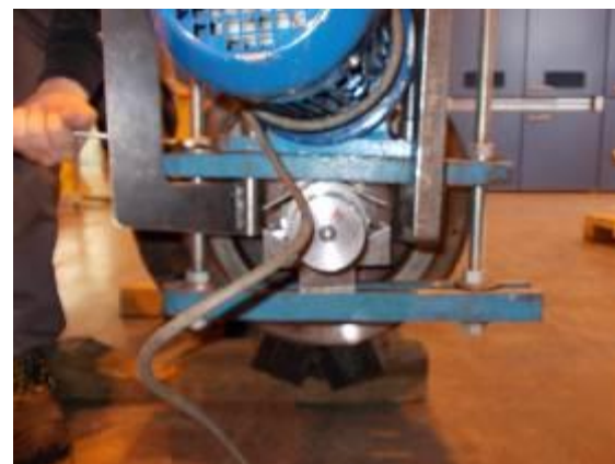
Фото 4: Специальная зажимная призма присоединяет к шипу вала.
