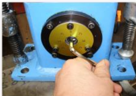
Фото 7: Здесь на эксцентрике настраивается вес детали. От 50 кг 3 % и до 20 тонн 100 % степени эксцентрика.
