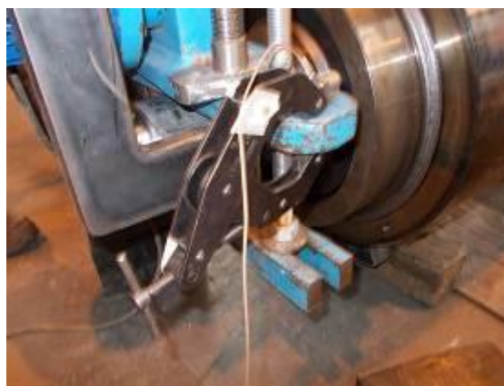
Фото 2 У этого вала, который весит больше 1 тонны, напряжения снимаются за 25 минут.
