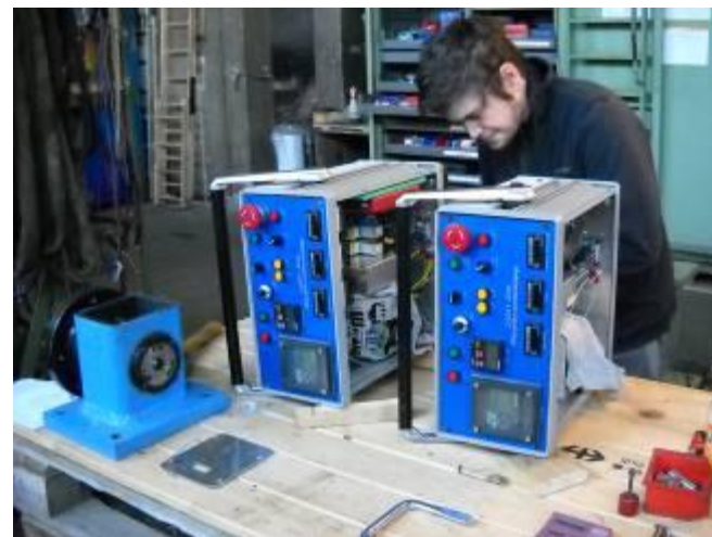
Фото 9: Монтаж установки для снятия напряжений WIAP LC 20 и вибратора LC 50
