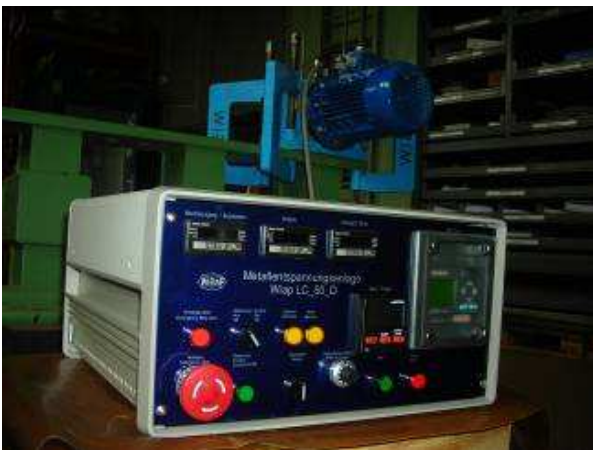
Foto 1): Die neue WIAP LC 50_D Anlage ist fertig. Ausgelegt für Werkstückgewichte bis 50 Tonnen (Foto CH 12_11_2012 hpw)
