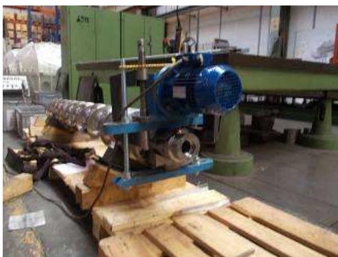
Foto 9): Rostfreie Schneckenwellen werden seit Jahrzehnten mit der WIAP LC Anlage entspannt (Foto CH 2012 hpw)
