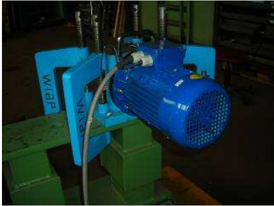
Foto 2): Die LC 50 Anlage hat einen 2.2 KW Motor; 400 Volt 100 Hz laufend. Der Vibrator wird mit den schweren WIAP Schraubzwingen befestigt. Eine schlechte Verbindung vom Vibrator zum Werkstück kann zu Entspannungsprozess Messungsverfälschungen kommen (Foto CH 16_08_2012 hpw)
