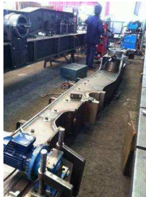
Foto 11): Auch Werkstücke für Transportgeräte werden mit Vibration entspannt. Sicher ist auch hier zweckmassig, dass diese Werkstücke welche danach dauernden Vibrationen ausgesetzt werden, vor dem Bearbeiten vibriert werden. (Foto 08_2012 CH hpw)
