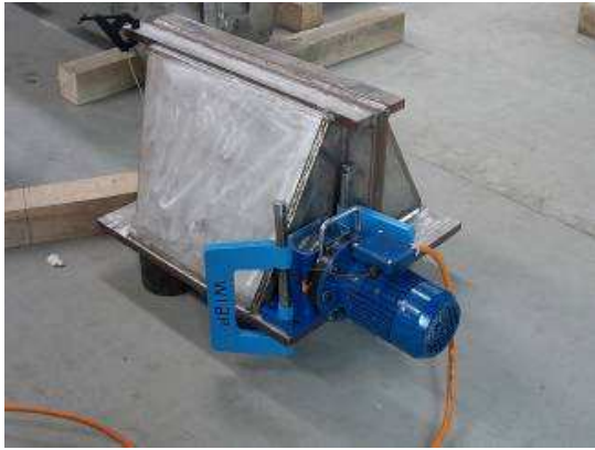
Foto 12): 2012 wurde eine WIAP Anlage LC 20 nach China geliefert. Diese Anlage entspannt hunderte Werkstücke. Rostfreie, schwere, geschweisste Werkstücke. Vibrieren ist der sichere, anwendbare Weg. (Foto CH 03_03_2012 hpw)
