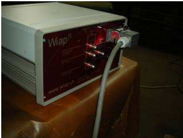
Geräte. Die 3 Koax Anschlüsse sind für die Protokollierung. (Foto CH 11_11_2012 hpw)
