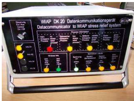
Foto 14): Das neue Datenkommunikationsgerät WIAP DK20 sorgt für eine Datenübertragung auf den Laptop. Diese Daten werden dann auf einer Excel Datei abgelegt und dort durch 3 Kanäle in 3 Fenster abgelegt. (Foto CH 2012 hpw)
