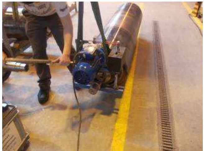
Foto 5): Diese Walzen werden 30 Minuten vibrationsentspannt (Foto CH 2012 hpw)
