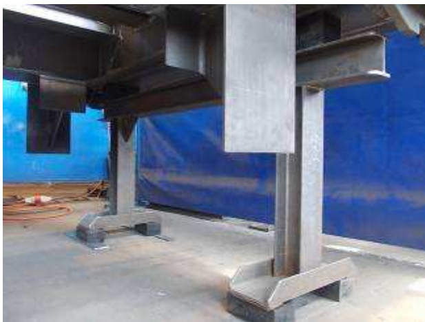
Foto 7): Ohne diese Gummi-unterlagen kann kein Werkstück mit Vibration entspannt zu werden. (Foto CH 2012 hpw )
