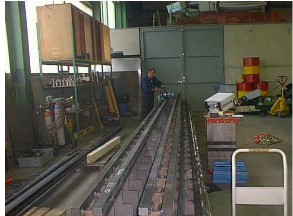
Foto 13b): Maschinenbett wurde mit Vibration entspannt. (Foto CH 16_08_2002 hpw)
