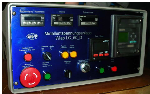
Foto 19): Die Anlage WIAP LC 50, für 20 Tonnen, arbeitet mit 2,2 KW Motor. (Foto CH 16_08_2012 hpw)
