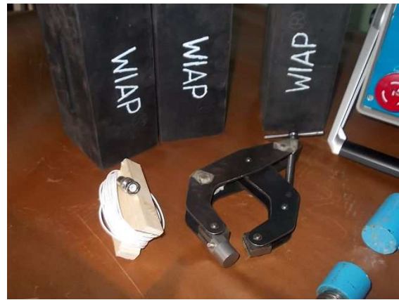
Foto 23) Sonde, Sondenkabel und Gummiunterlagen (Foto CH 16_08_2012 hpw)
