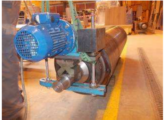
Foto 4): Viele solcher Walzen werden im tausendstel mm nach dem Verchromen eingesetzt. Versuche zeigten, dass durch das Verchromen Spannungen in das Werkstück kommen. Versuche mit Glühen und das Vibrieren haben bestätigt, dass mit dem Vibrationsentspannen die Spannungen, welche beim Verchromen eingebracht werden, wieder beseitigt werden können. Das Glühen brachte in dem Fall kein Erfolg mehr. Das heisst: Das System „Entspannen mit Vibration“, ist der richtige Weg. Auch bei Spannungsproblemen nach dem Hartverchromen. Wir, als Entspannungsanlagen Hersteller, sind aber noch gefordert. Bessere Aufspannvorrichtungen für die Serienfabrikation, damit der Prozess 100% sicher und dokumentierbar ist. (Foto CH 2012 hpw)
