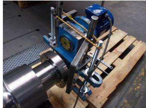
Foto 10): Das Aufspannen des Vibrators benötigt robuste Vorrichtungen (Foto CH 2012 hpw)
