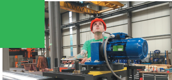
Walzen beim Metall entspannen mit Vibration (MEMV®) - Jim Peter Widmer - April 2017 (hpw)
