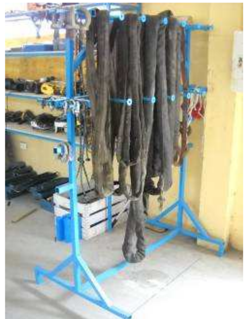
P7b: Manche Transport Seile (Gurten) haben wir hier, ist aber noch nicht fertig. Alle Gestelle haben wir selber gemacht, die Studenten haben sie zusammengeschweisst.
