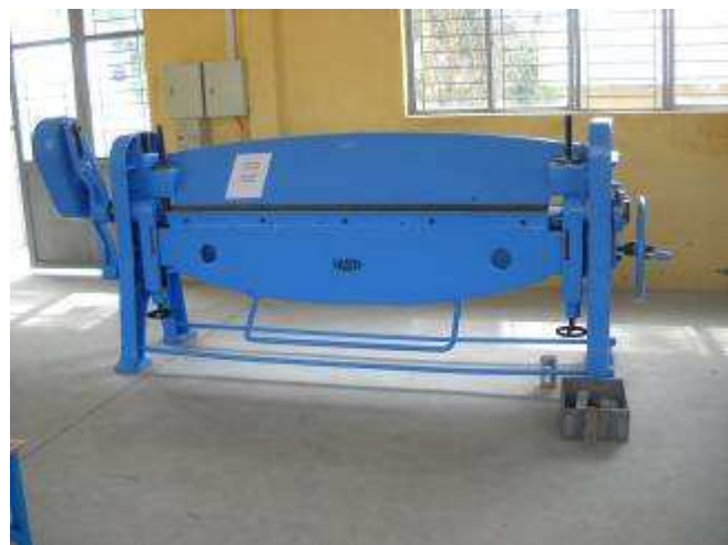
P21: Abkant Maschine, Asti 2000mm max. 2mm.
