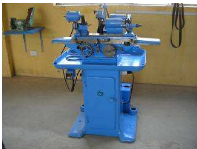
P18: Rund Schleifmaschine, FST Deutschland. Spitzen Höhe 75mm, Spitzenweite 300mm.
