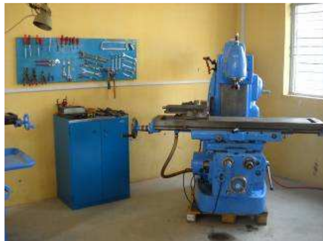
P10: Induma Fräsmaschine ISO 50, Tisch 300x1500 mm.
