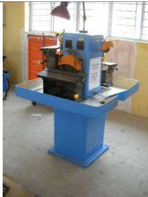
P13: Hier eine Werkzeug Schleifmaschine Solid DS3. Wir haben viele Drehwerkzeug, Stein und Diamant Schleifer für das Werkzeug.
