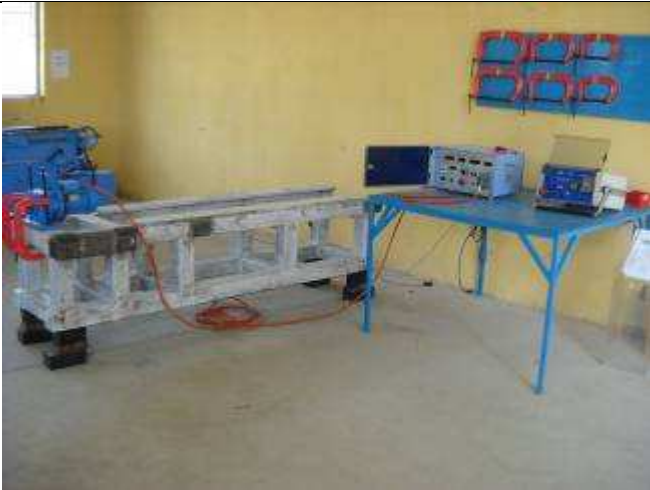
P23a: Metallentspannungs Zone in Raum 1b. Eine alte Wiap LC20 Anlage und eine neue sind in Betrieb. Bis zu 20 Tonnen möglich. Auf unserem Boden nur 1 Tonne möglich.
