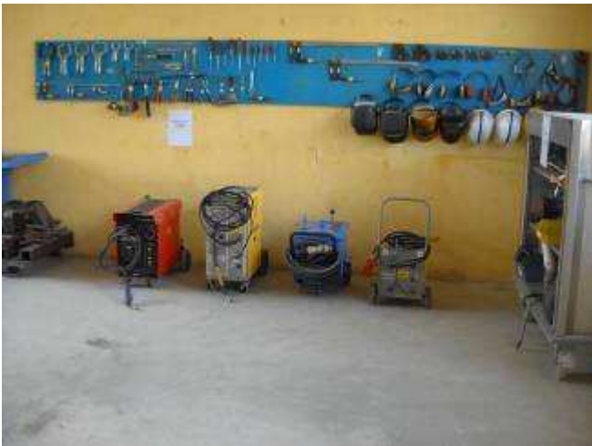
P24: Schweißzone, zwei Schutzgas und zwei Elektroden Anlagen alle bis 200 Amp.
