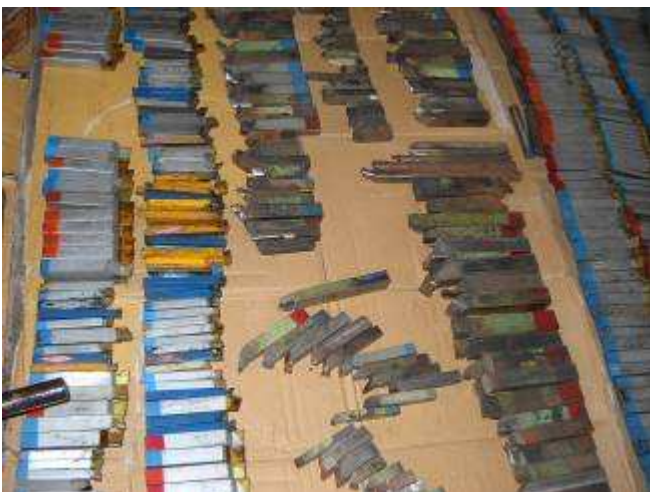
P22: Im Lager bei Hieu hatten wir noch einige Palette Drehstähle diese haben wir jetzt noch geholt und hergerichtet.
