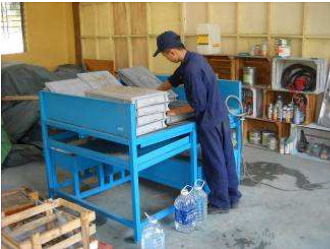
P21. Auch unser Waschplatz der ohne Lösungsmittel funktioniert, hat schon viele Stunden genutzt werden können.(Eigenkonstruktion von uns 3 Schmutzkammern)
