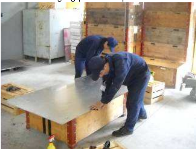
P23: Die Blechtafeln die wir mitnahmen, hatten Rostspuren von der Fracht. Die Jungen putzen es gut.
