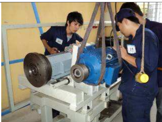
Photo 14: Nun klappt es? Noch einmal demontieren und die Riemenspannung noch vorbereiten.
