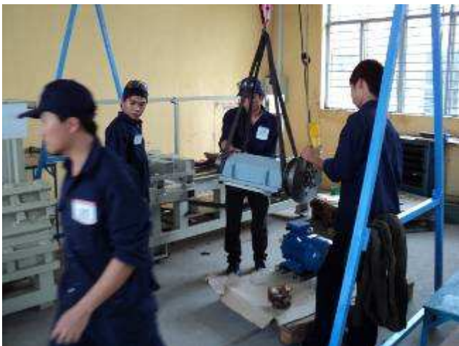
Photo 10: In der Montage wird man auch immer eigenständiger. Es ist nicht zu unterschätzen die Lasten verbergen auch Gefahren in sich, man muss da immer zuerst denken bevor man handelt. Meine Weisung ist, nie ein Körperteil unter die Lasten halten, lieber etwas defekt, als ein Knochen weg. Aber denken, Kopf bei der Sache haben!
