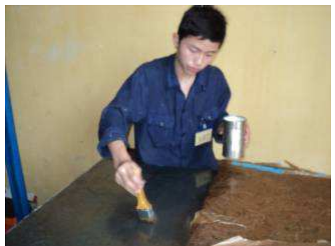
Photo 33: Alles was blank ist, mussten die Lehrlinge jetzt mit einem Oel Fettgemisch einstreichen und zudecken mit Oelpapier.
