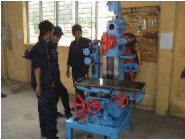
Foto22: Diese alte Fräsmaschine kauften wir auch im Ricardo. Weil unten eine Spindel rausguckt, mussten wir ein Ständer machen, dass die Maschine ca. 250mm ab Boden ist. Für uns ist es aber wichtig, dass die Lehrlinge lernen: Auch mit alten Maschinen kann man leben.
