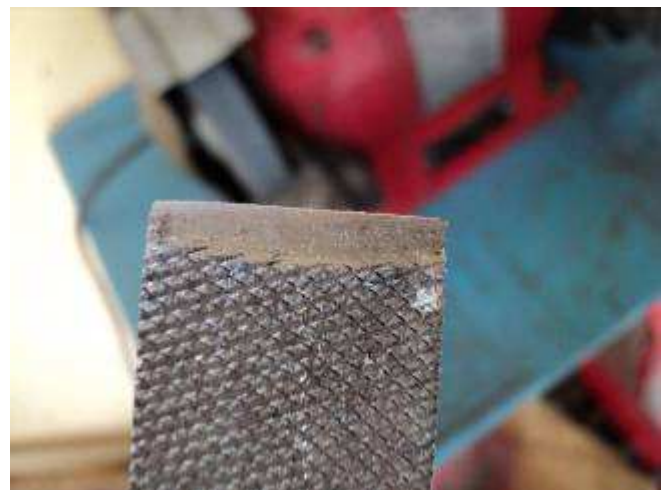
Foto 15: Aus einer Flachfeile einen Schaber zu machen ist eine einfache und gute Variante.
