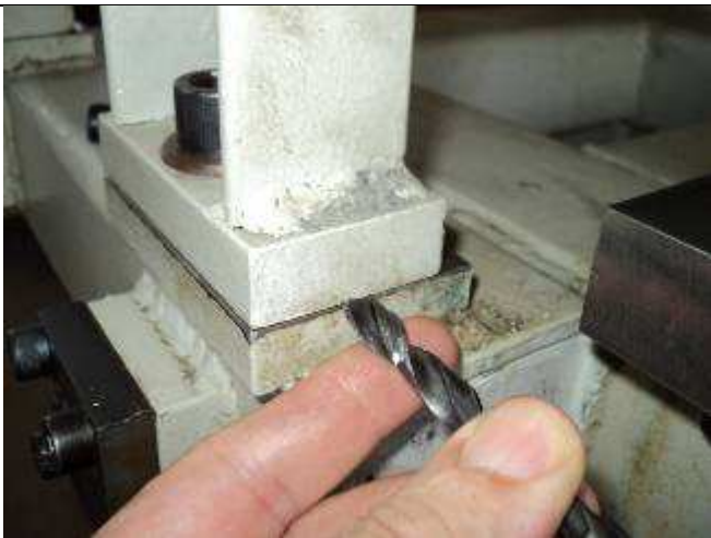
Foto 22: Eine Alternative wie man auch konische Stifte setzen kann seitwärts.
