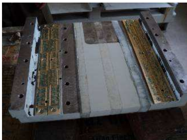
Foto 5: Der Schlitten hat schon einige Drehungen gemacht. Diese Schaberei ist schon zeitaufwendig.
