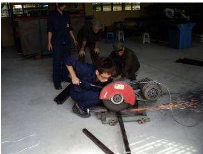
Foto 12: Ehrlich gesagt, um Rohre zu trennen ist diese Maschine besser als unsere Bandsäge. Ein Blatt kostet 1 CHF.
