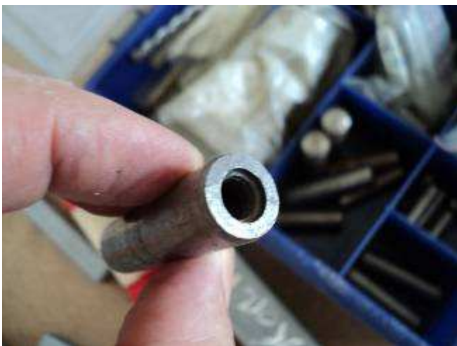
Foto 23: Konische Stifte ohne Gewinde. Unsere Lehrlinge bohren sie dann eben selber von Hand. Wieder etwas gelernt.
