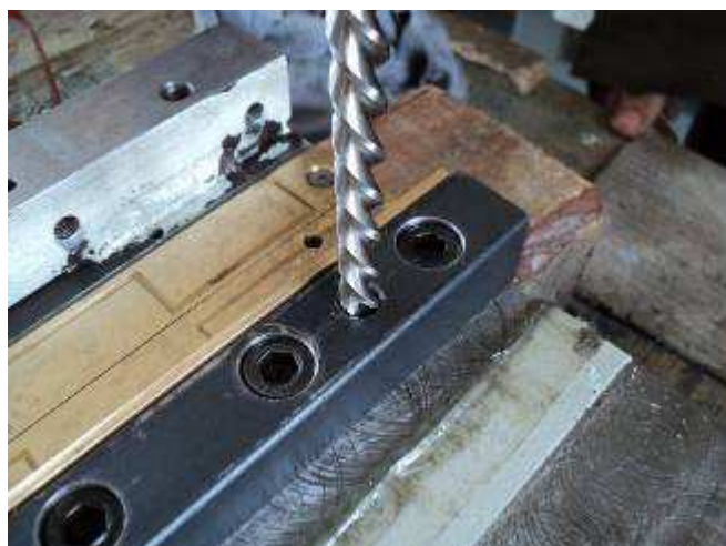
Foto 20: Noch einmal zum konischen Verstopfen: hier eine Maschinen Reibahle im Einsatz
