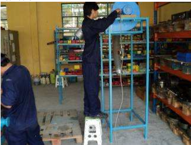
Foto 30: Für die Malerei machen wir in der Montage einen zusätzlichen Absauglüfter. Diesen brachten wir mit aus der Schweiz aus einer Schreinerei. Hier leistet er uns gute Dienste.
