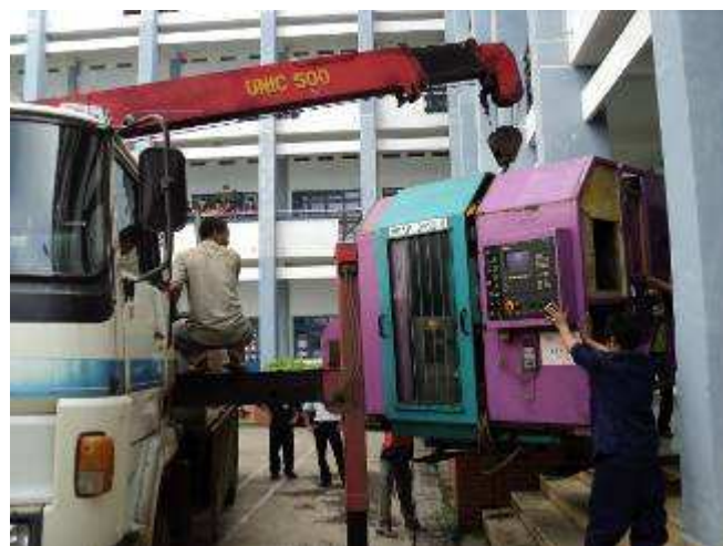
Foto 9. Mit einem 7 Tonnen Kran holen wir die 5 Tonnen Maschine raus.
