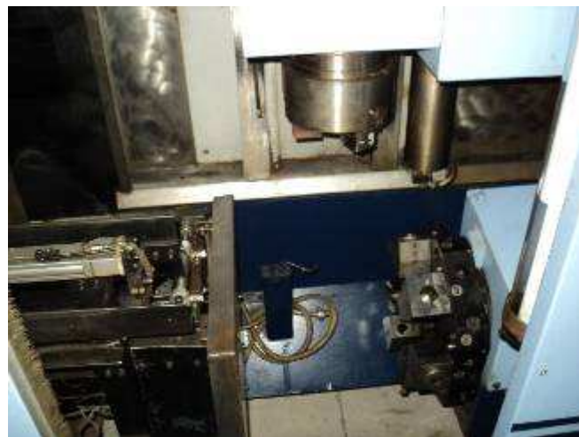
Foto 23. Hier etwas aus dem Maschinenraum der DM2V. Diese Maschine macht alles automatisch, Teil holen, drehen, zurückbringen u.s.w
