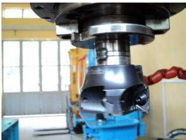
Photo 26. Warum haben die Lehrer hier am Fräswerkzeug die Distanzringe angeschweisst? Wenn man richtig hinsieht, sieht man, dass sie den Konus nicht richtig montierten. Bis heute wissen wir nicht, wer das war!
