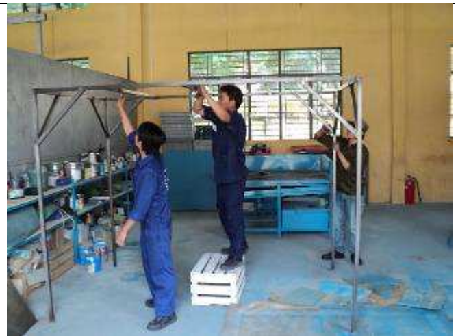
Photo 2: Das Gestell für den Spritzraum ist auch bald fertig.
