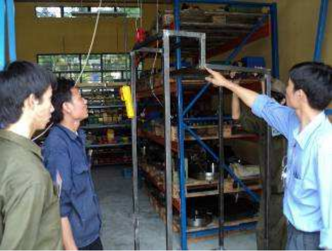
Photo 34: Hier haben wir ein neuer Absaug Ventilator Ständer gemacht, damit wir in der Malerei noch einen zweiten Absauger montieren können. Lehrer Robinson zeigt die Qualitätskontrolle. Kleine Löcher in den Schweissnähten, das geht zurück nachbessern.
